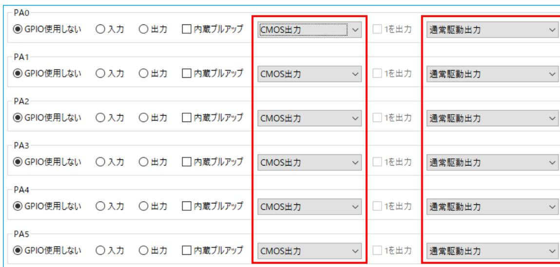
図 2-3 未使用端子の CMOS 出力/Nch オープンドレイン出力設定および高駆動設定
