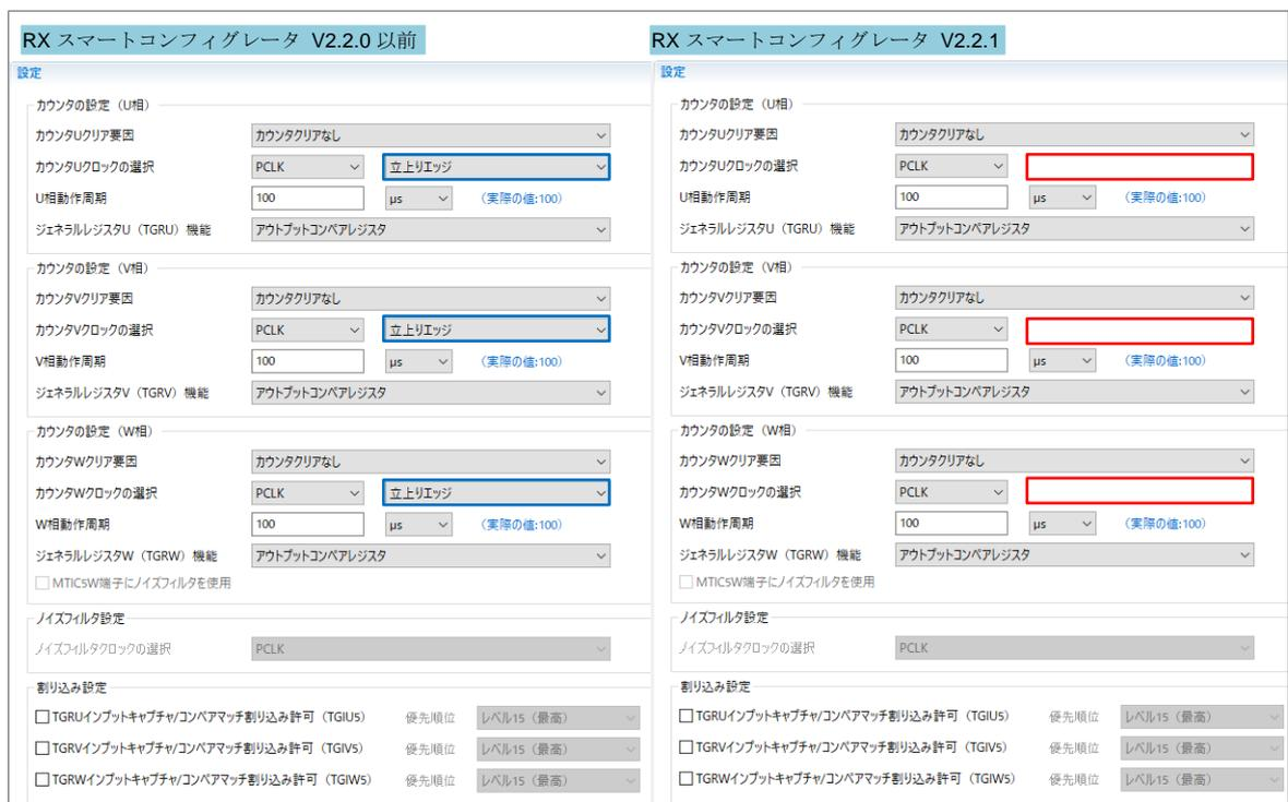
図 3-9 RX66T 64pin パッケージのクロックエッジ選択
