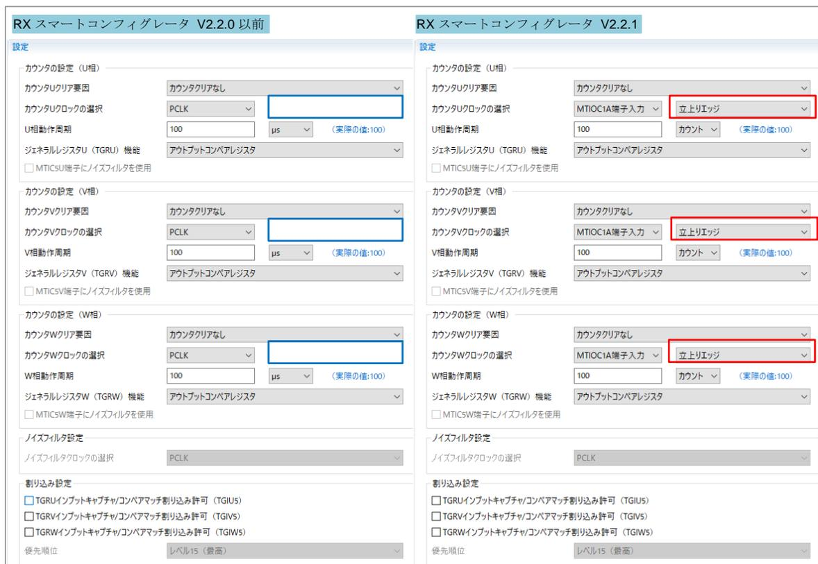
図 3-7 RX23T, RX24T, RX24U のクロックエッジ選択
