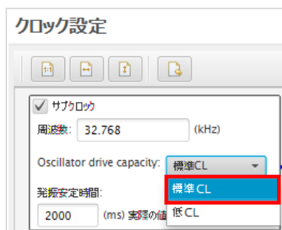
図 3-3 発振器ドライブ能力の選択肢
