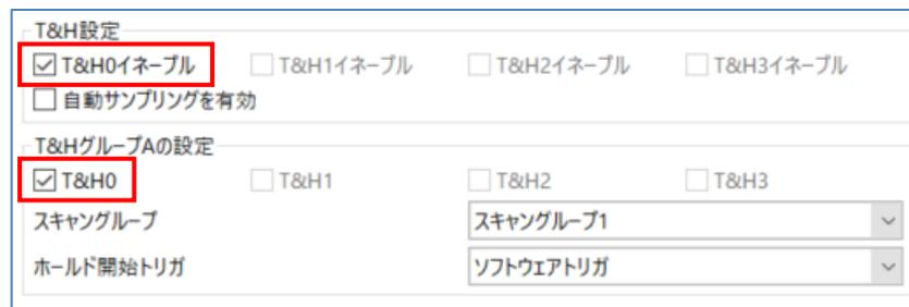
図 3-1 A/D コンバータの T&H 機能設定
