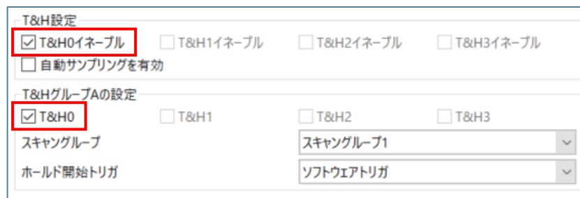
図 3-1 A/D コンバータの T&H 機能設定
