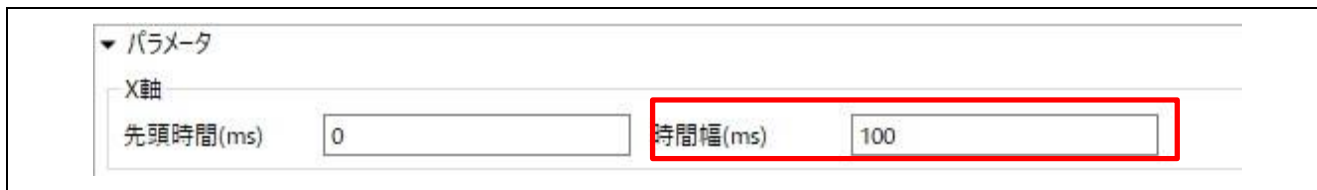
図 1-5. X 軸の時間幅の設定
