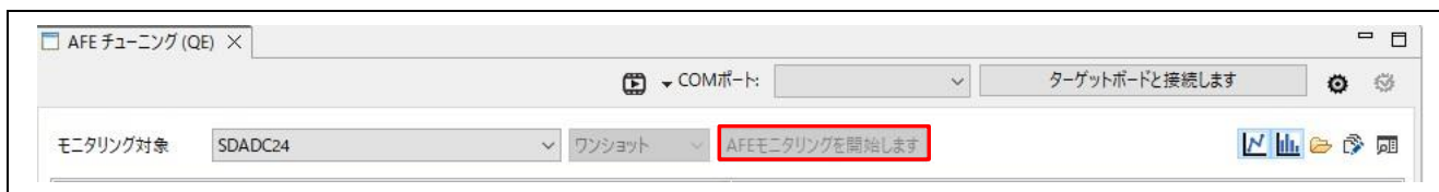
図 1-6. [AFE モニタリングを開始します] ボタンの位置
