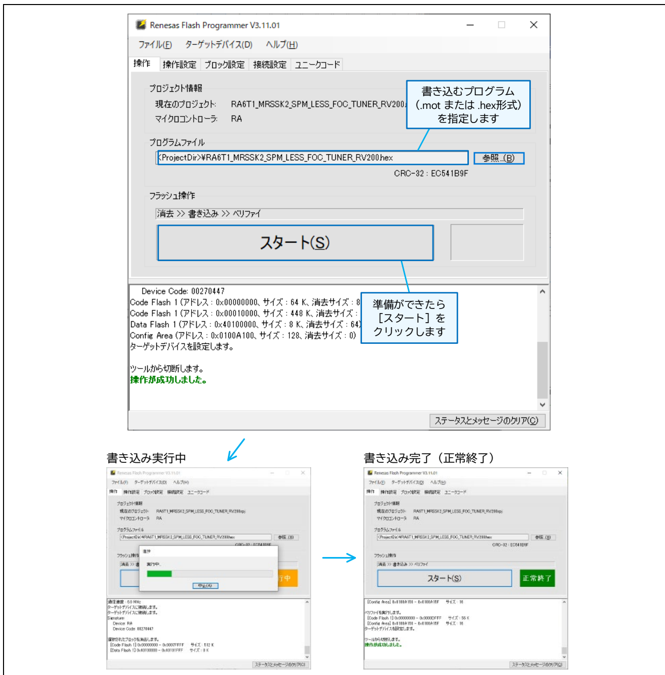
図 2-14 Renesas Flash Programmer による実行プログラムの書き込み (2/2)
