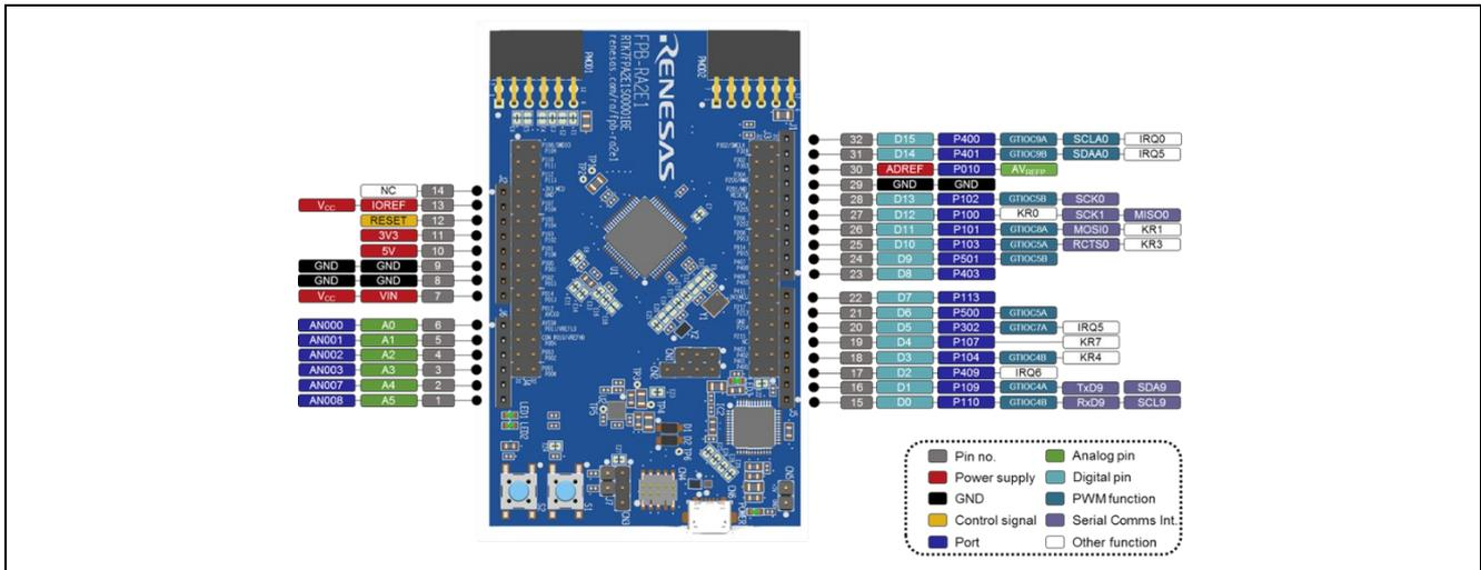
図 2 FPB-RA2E1 Arduino インタフェース
