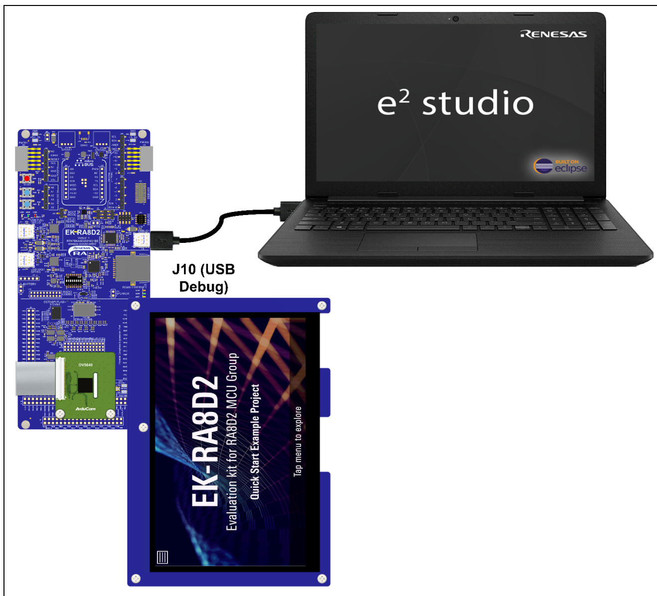
図 36. USB デバッグポートを使用した EK-RA8D2 ボードとホスト PC の接続
