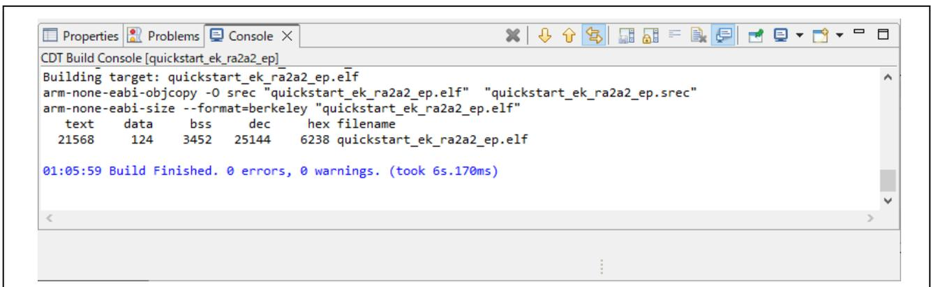
図 20. 成功したビルドの出力
