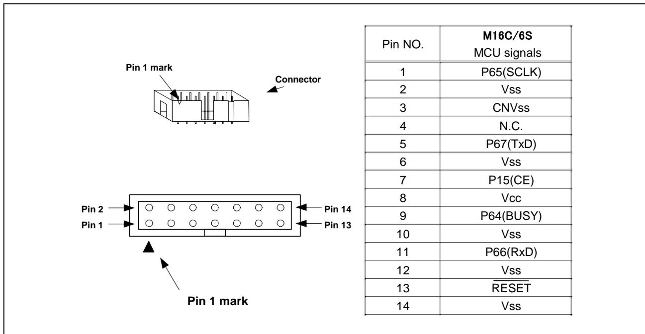
図 4.1 E8 接続コネクタのピン配置
