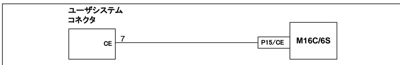
図 5.3 E8 エミュレータと P15 端子の接続
