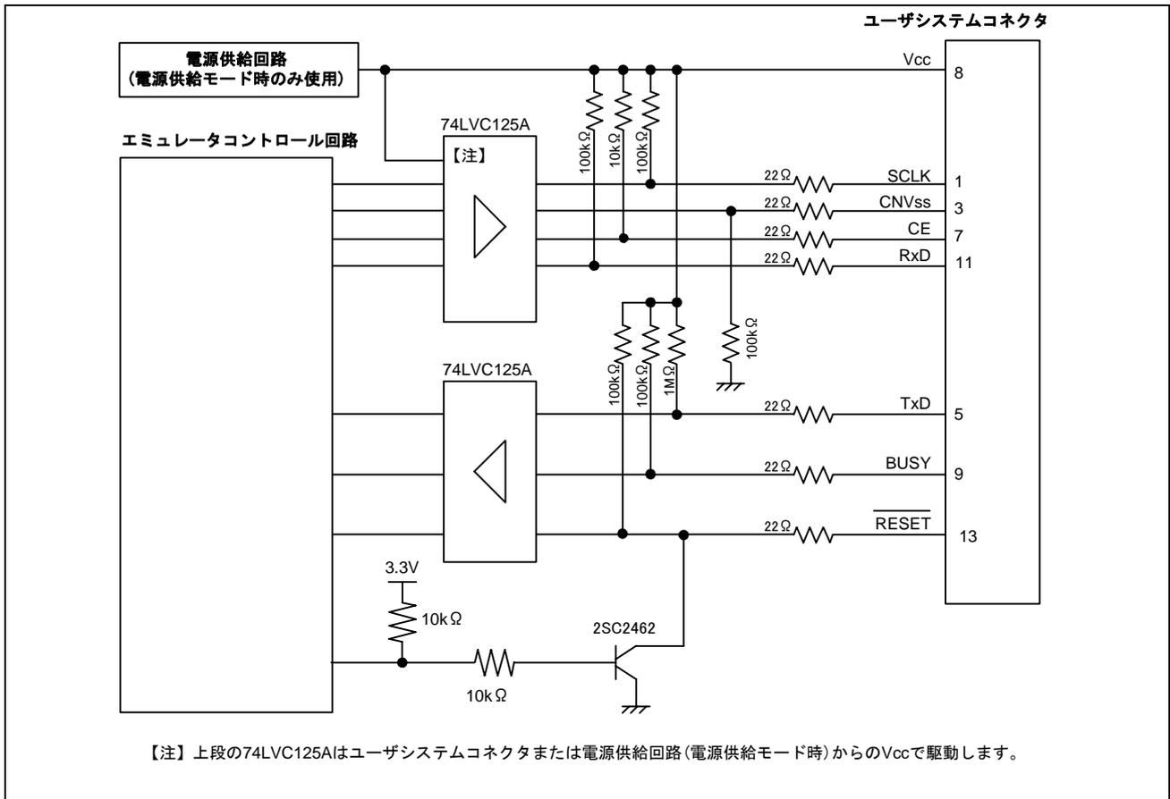
図 5.6 E8 エミュレータ内インタフェース回路 (参考)
