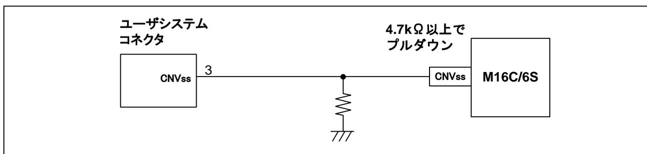
図 5.4 E8 エミュレータと CNVss 端子の接続
