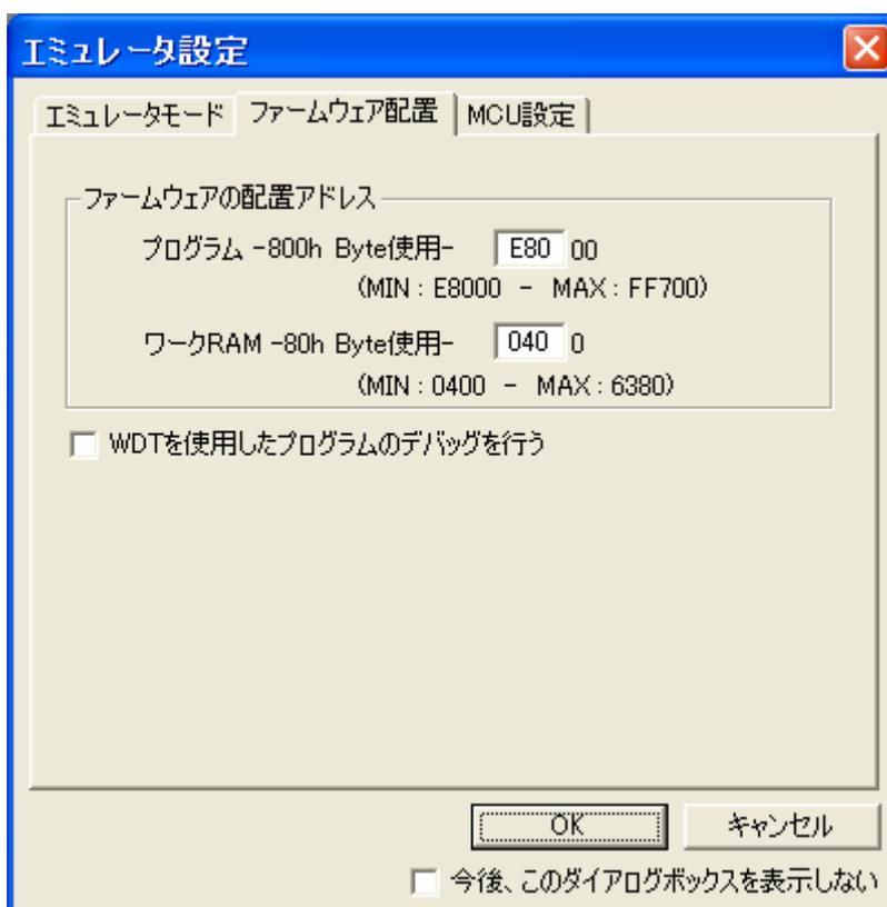
図 6.1 [エミュレータ設定] ダイアログボックスのファームウェア配置タブ
