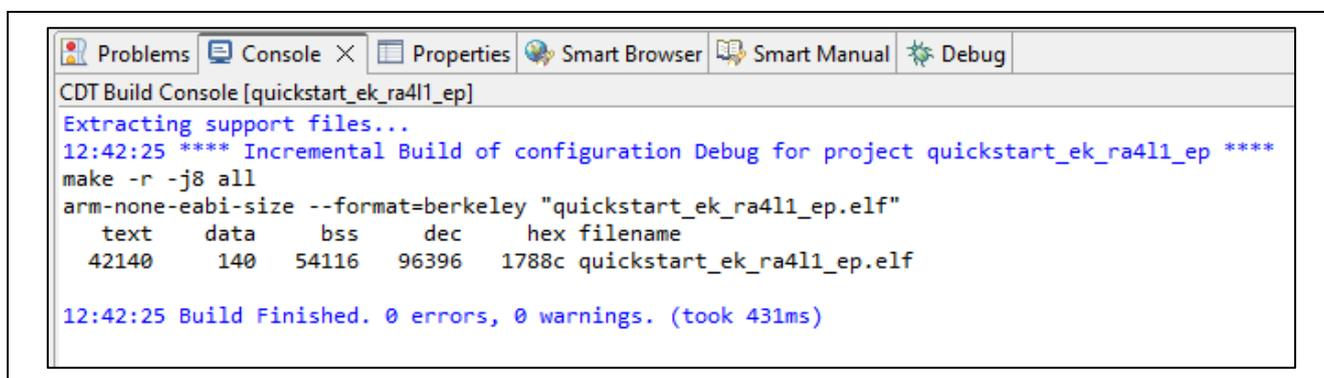
図 31. 成功したビルドの出力
