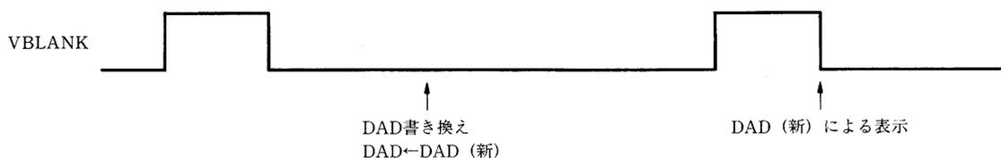
注 VBLANK信号は、AGDCの内部信号であり、外部に出力されているのはBLANK (HBLANKとVBLANKの論理和) 信号です。
