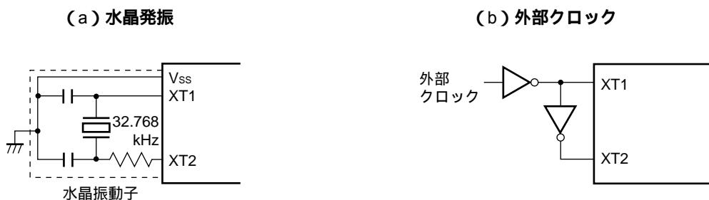
**注意** サブシステム・クロック発振回路を使用する場合は、配線容量などの影響を避けるために、図5-6の破線の部分を次のように配線してください。
