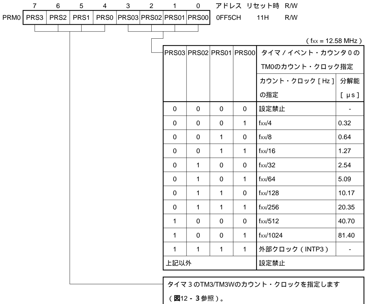
図9-3 プリスケアラ・モード・レジスタ0 (PRM0) のフォーマット
