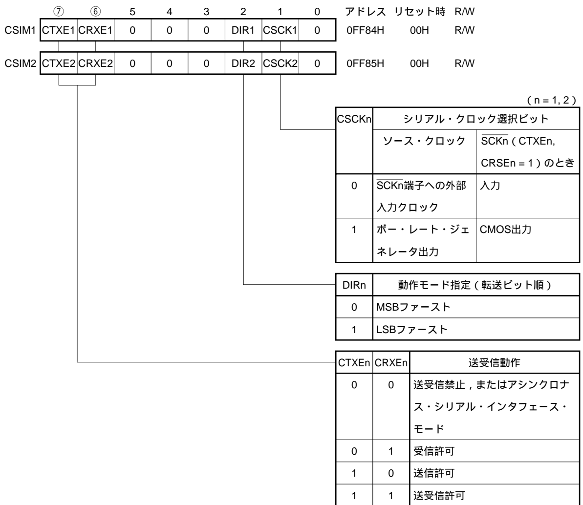
図18-11 クロック同期式シリアル・インタフェース・モード・レジスタ1 (CSIM1), クロック同期式シリアル・インタフェース・モード・レジスタ2 (CSIM2)のフォーマット
