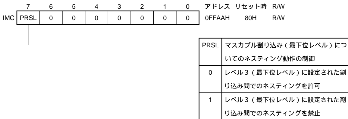
図23 - 4 割り込みモード・コントロール・レジスタ (IMC) のフォーマット
