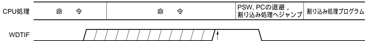
図16 - 8 ノンマスクابل割り込み要求の受け付けタイミング
