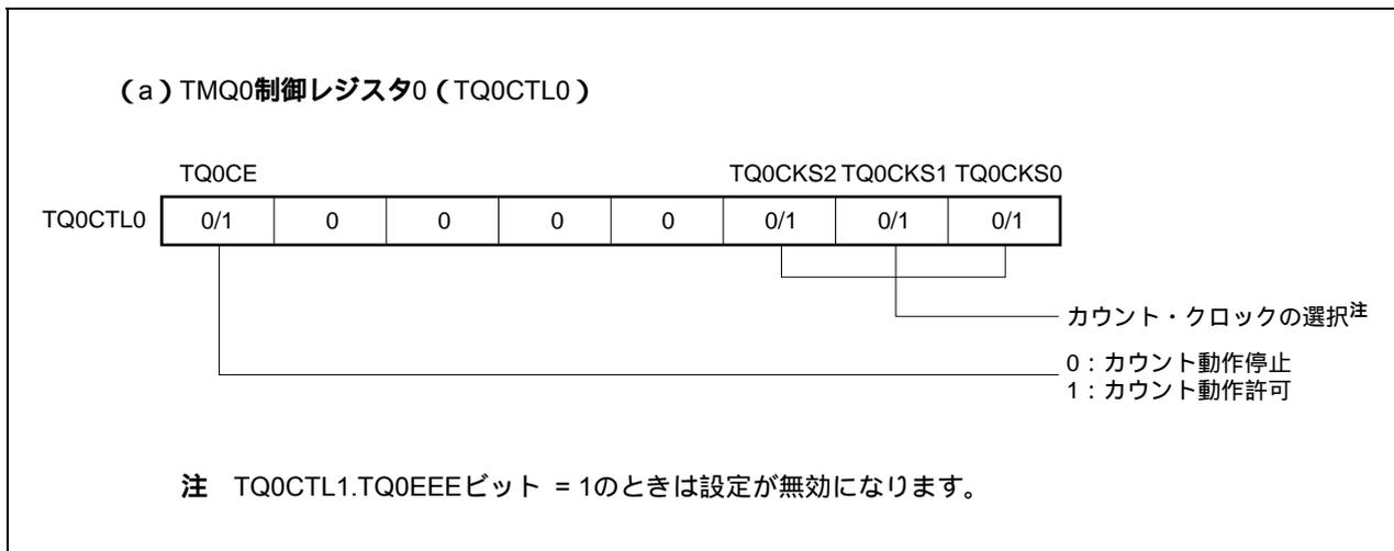
図8 - 18 外部トリガ・パルス出力モード動作時のレジスタ設定内容 (2/3)
