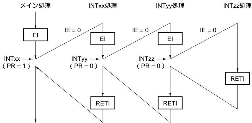
割り込みINTxx処理中に、2つの割り込み要求INTyy、INTzzが受け付けられ、多重割り込みが発生する。各割り込み要求受け付けの前には、必ずEI命令が発行され、割り込み要求受け付け許可状態になっている
