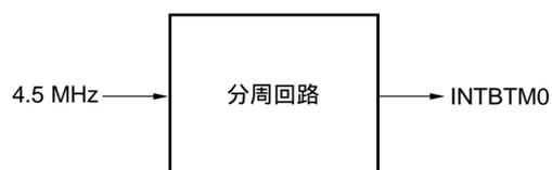
**注意** ベーシック・タイマは、電源投入後および $\overline{\text{RESET}}$ 端子によるリセット後に、DTSシステム・クロック選択レジスタ (DTSCK) のビット0 (DTSCK0) に1を設定してから使用してください (5.1 クロック発生回路の機能を参照)。
