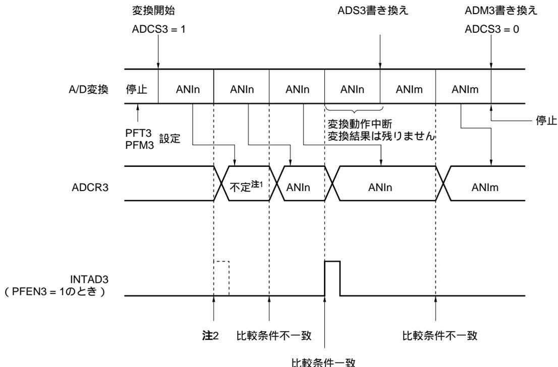
注1 . A/D コンバータ・モード・レジスタ3 (ADM3) のビット7 (ADCS3) に1を設定 (変換動作開始) した直後の変換データは不定になります。
