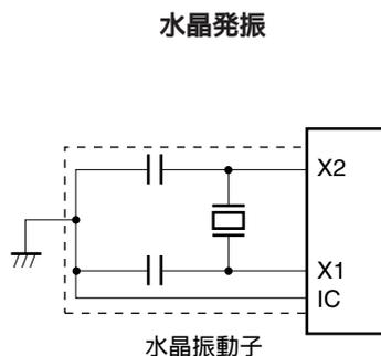
**注意** システム・クロック発振回路を使用する場合は、配線容量などの影響を避けるために、図5 - 4の破線の部分を次のように配線してください。
