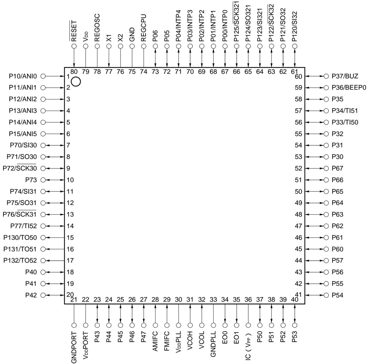
注意 1. IC (Internally Connect) ,  $V_{PP}$  端子はGNDに直接接続してください。
