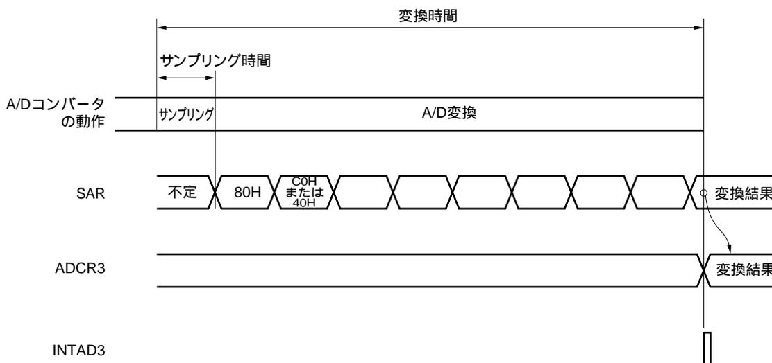
A/D変換動作は、ソフトウェアによりADM3のビット7 (ADCS3) をリセット ( 0 ) するまで連続的に行われ
