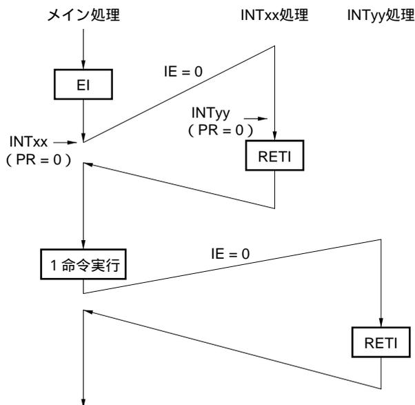
割り込みINTxx処理では割り込みが許可されていない (EI命令が発行されていない) ので、割り込み要求INTyyは受け付けられず、多重割り込みは発生しない。INTyy要求は保留され、メイン処理 1 命令実行後に受け付けられる。
