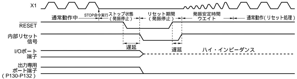
図16 - 3 ウォッチドッグ・タイマのオーバーフローによるリセット・タイミング
