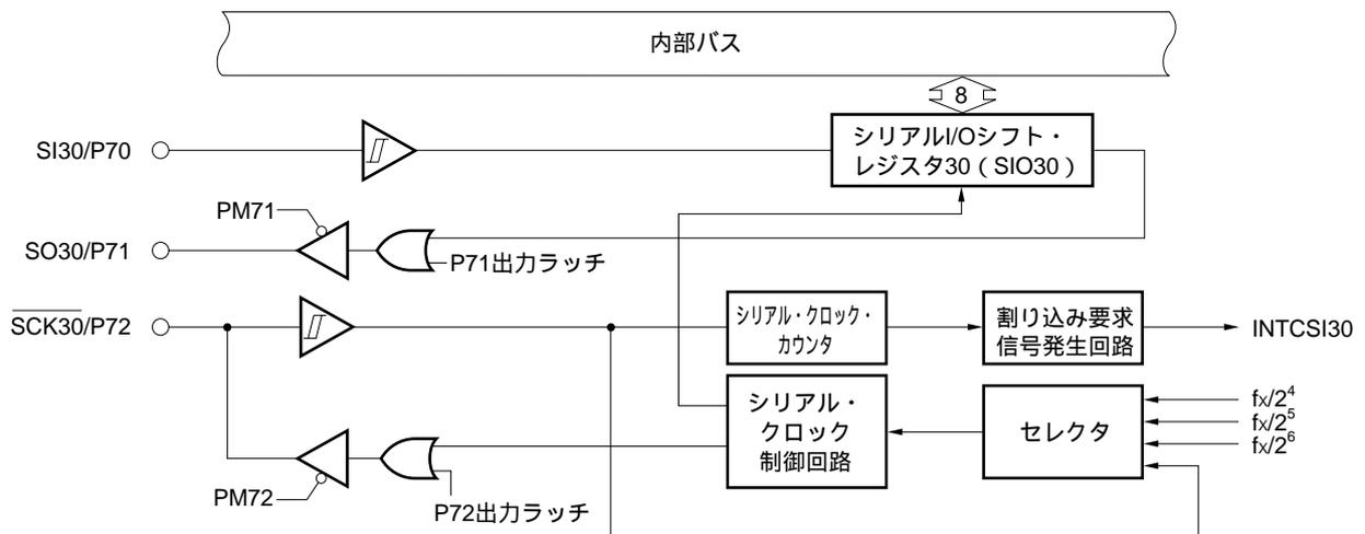
図11 - 2 シリアル・インタフェースSIO31のブロック図
