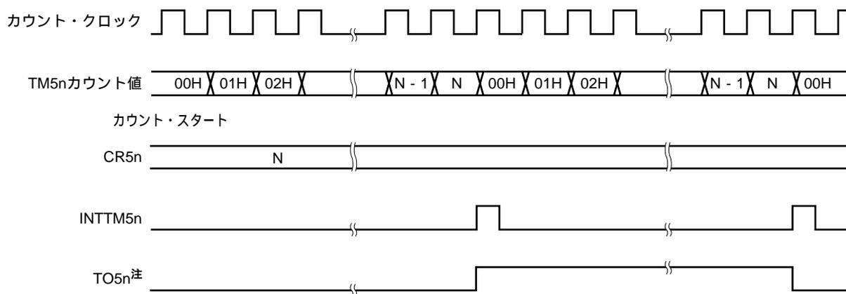
注 TO5n出力の初期値は，8ビット・タイマ・モード・コントロール・レジスタ5n（TMC5n）のビット2，3（LVR5n, LVS5n）で設定できます。
