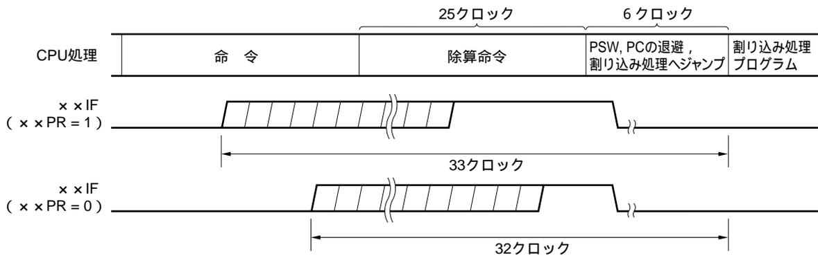
備考 1クロック :  $1/f_{CPU}$  ( $f_{CPU}$  : CPUクロック)
