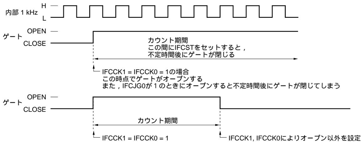
**注意** このゲートがオープンしている間にIFCSTによりカウントのスタートを設定すると、不定時間後にゲートが閉じてしまいます。したがって、ゲート時間にオープンを使用する場合は、IFCSTをセット(1)しないでください。
