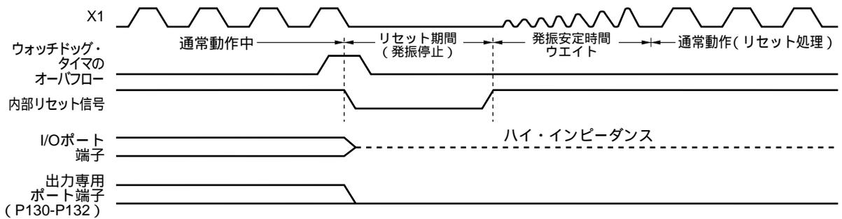
図16-4 パワーオン・クリアによるリセット・タイミング
