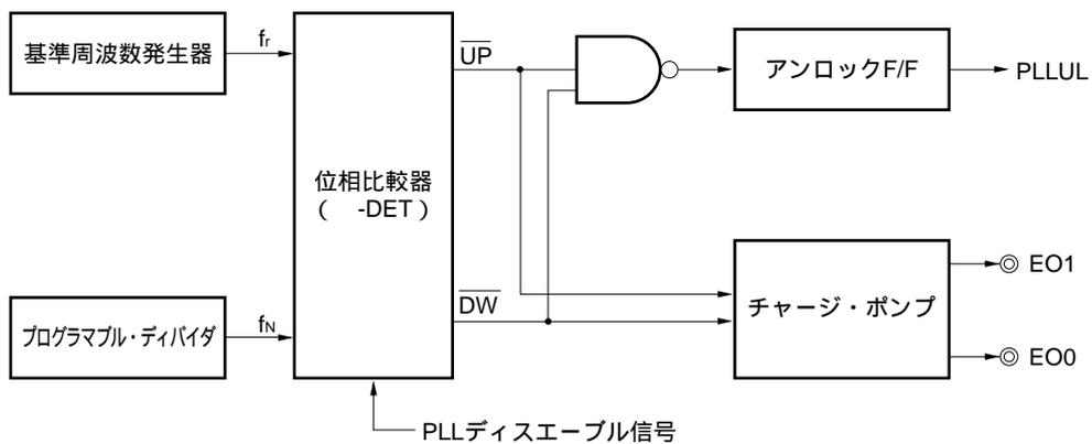
図13 - 9  $f_r$ ,  $f_N$ ,  $\overline{UP}$ ,  $\overline{DW}$ 信号の関係
