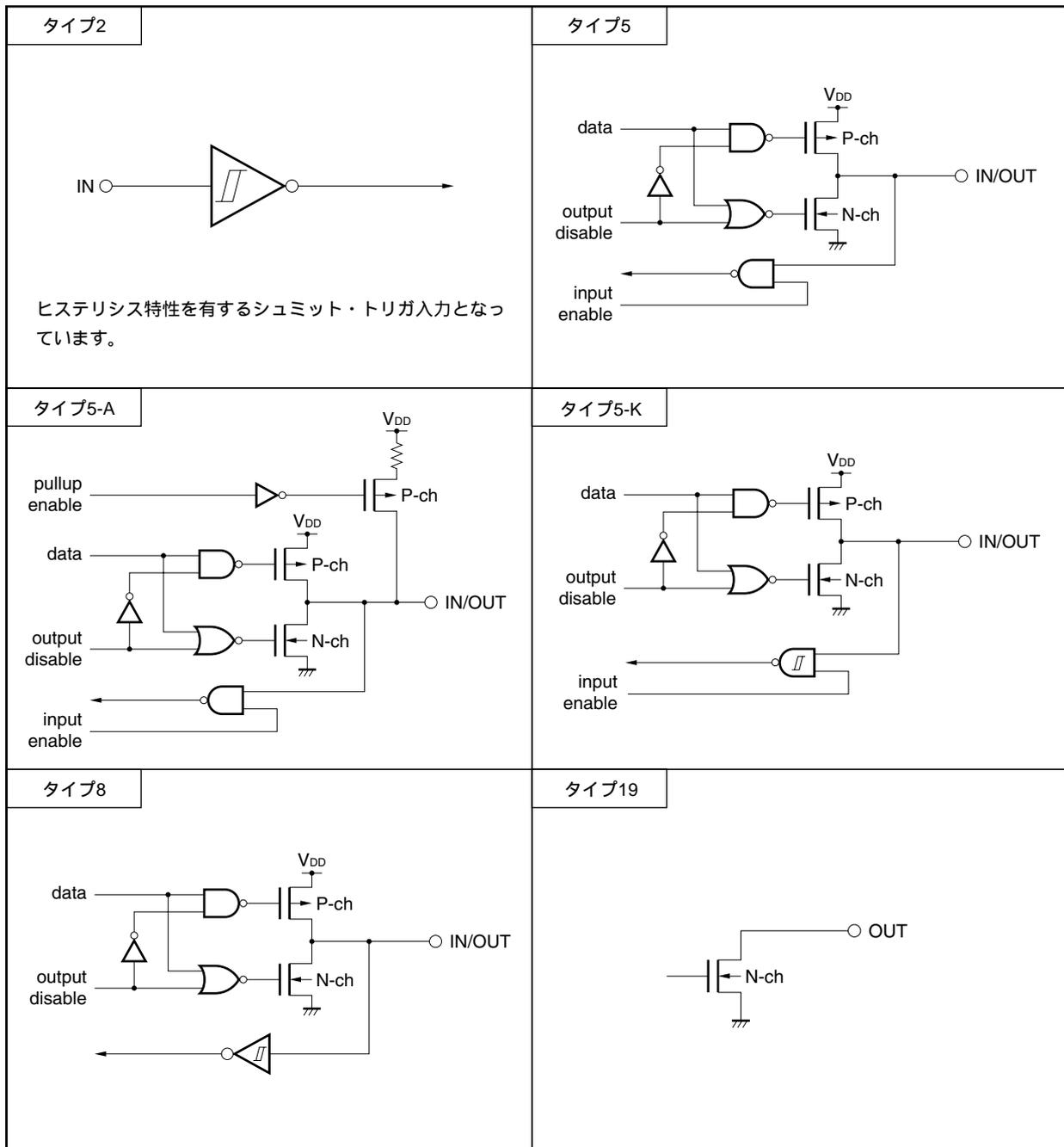
**備考** V<sub>DD</sub>およびGNDは、すべてポート部への正電源およびグランド電位です。それぞれV<sub>DD</sub>PORT, GNDPORTと読み替えてください。
