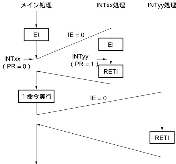
割り込みINTxx処理中に発生した割り込み要求INTyyは、割り込みの優先順位がINTxxより低いため受け付けられず、多重割り込みは発生しない。INTyy要求は保留され、メイン処理1命令実行後に受け付けられる。
