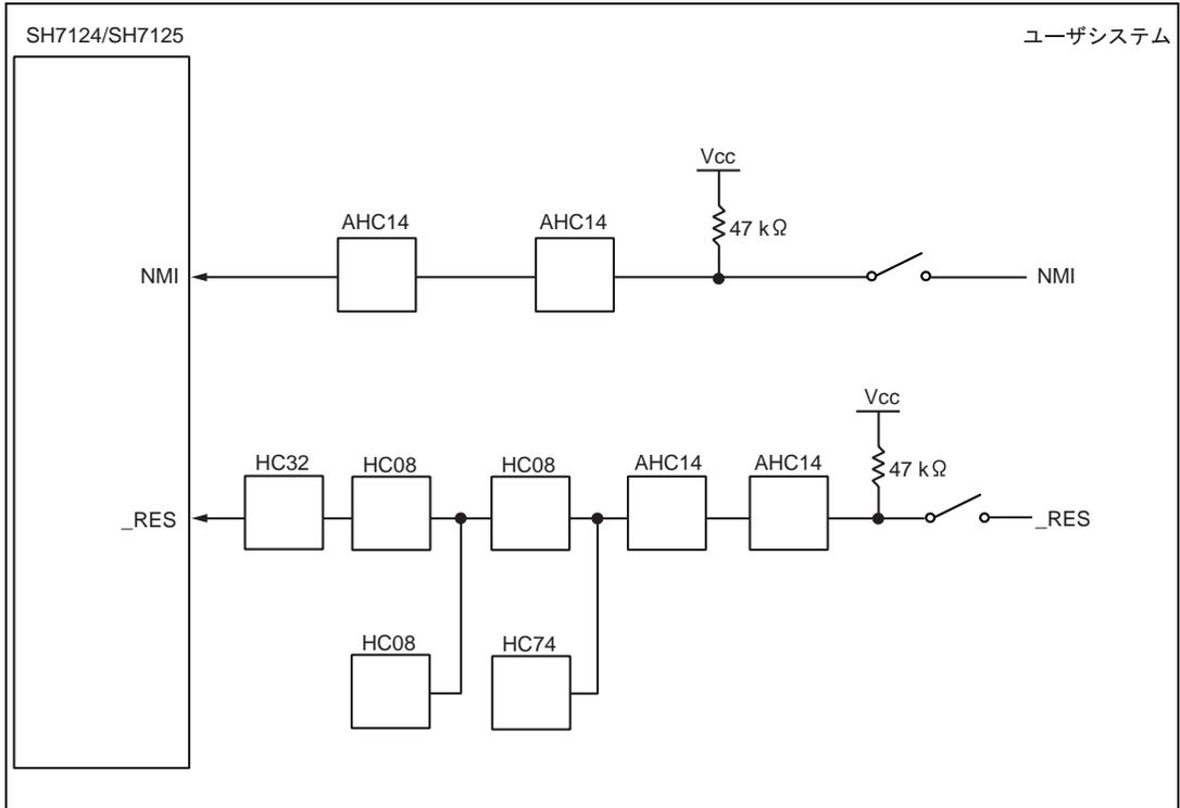
図 3.11 ユーザインタフェース回路(3)
