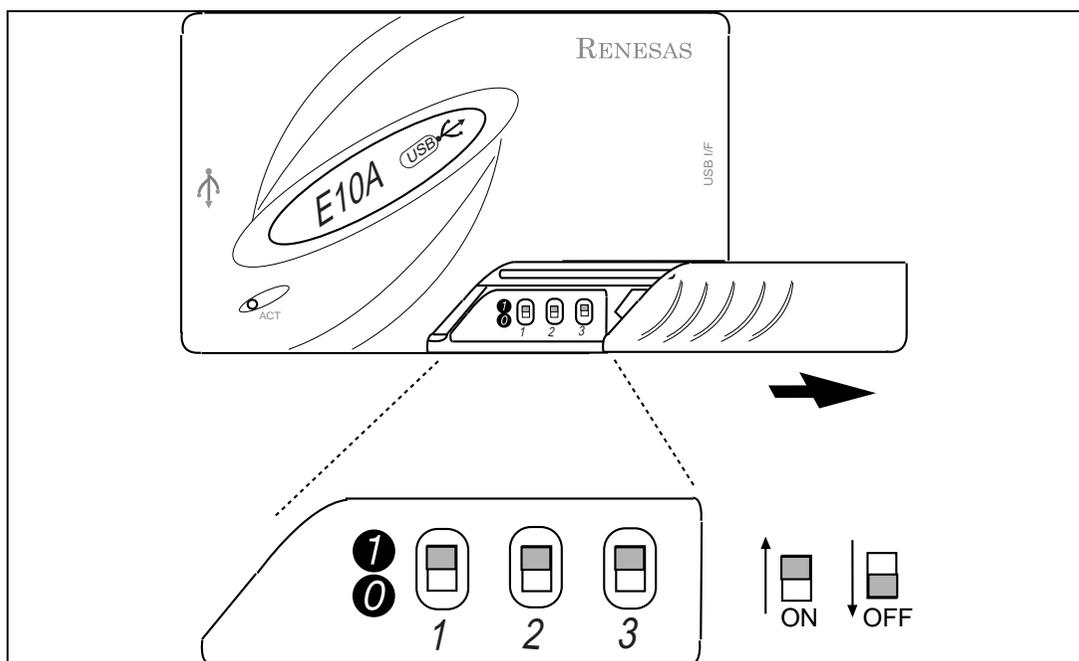
図 2.12 E10A-USB エミュレータの DIP スイッチ設定
