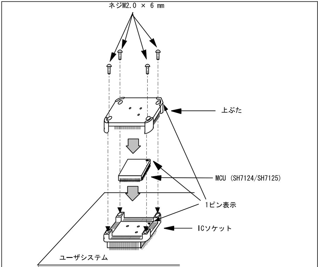
図 3.8 MCU をユーザシステムに実装する場合
