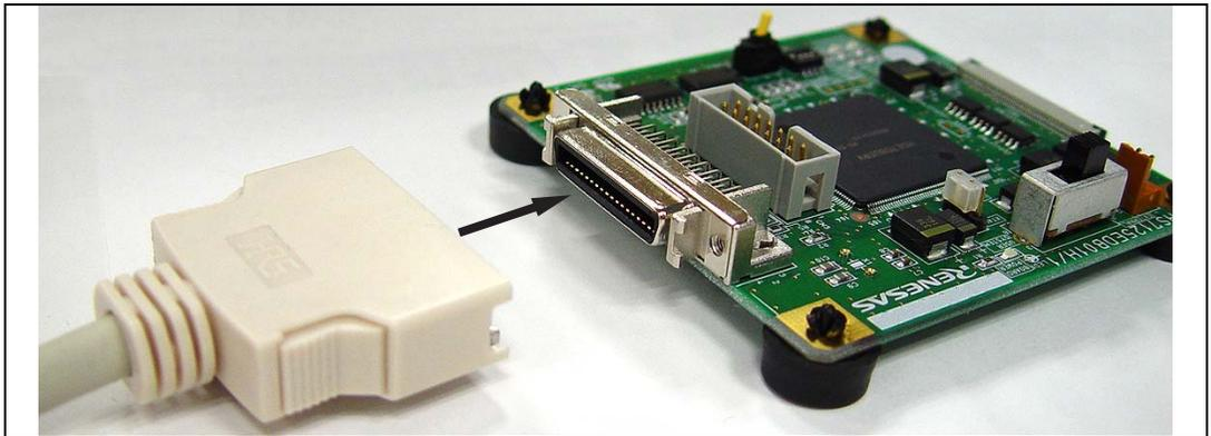
図 2.3 デバッグ MCU ボードとユーザインタフェースケーブル(36 ピン)の接続
