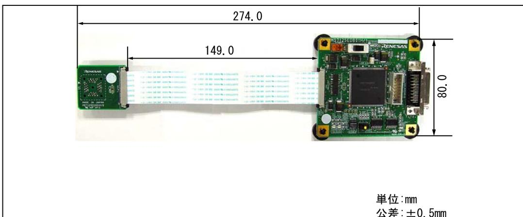
図 3.1 デバッグ MCU ボードの外形寸法図
