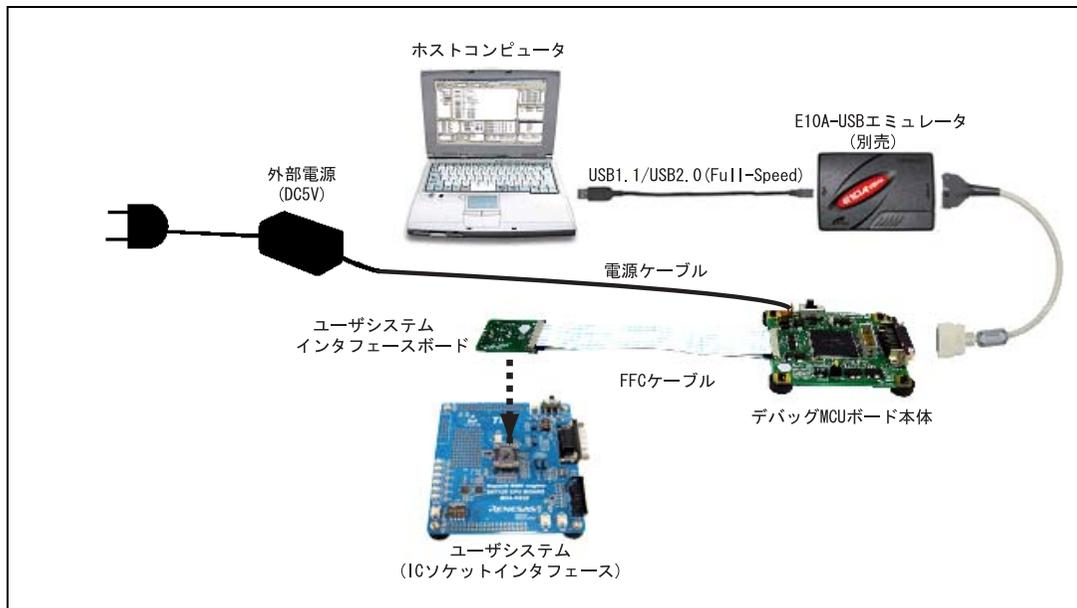
図 1.2 デバッグ MCU ボードのハードウェア構成
