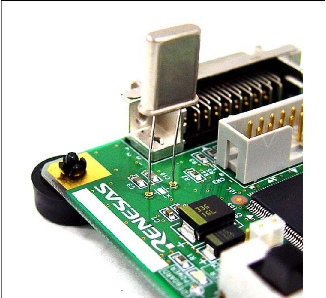
図 2.9 水晶発振子の実装
