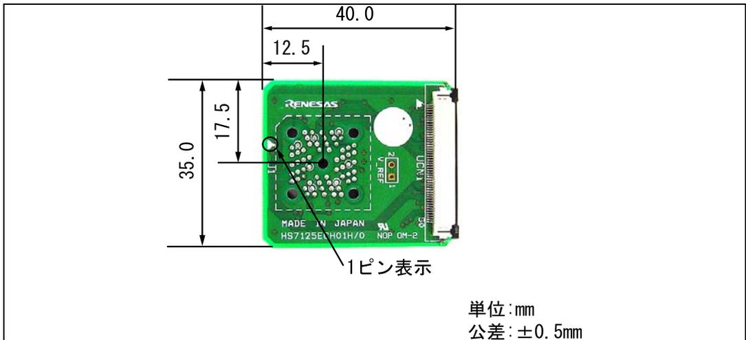
図 3.3 ユーザシステムインタフェースボードの外形寸法図
