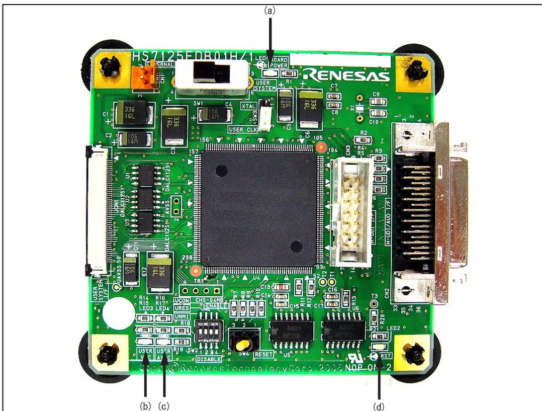
図 1.3 デバッグ MCU ボード本体の上面(1)
