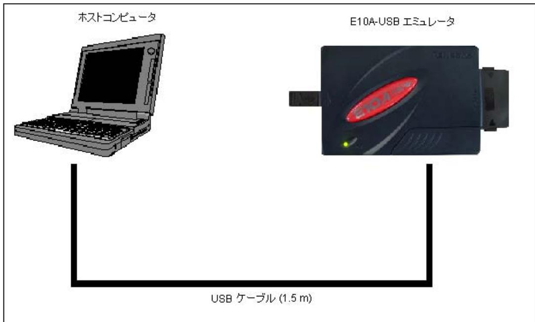
図 2.13 E10A-USB エミュレータのホストコンピュータ接続システム構成
