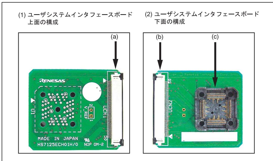
図 1.7 ユーザシステムインタフェースボード
