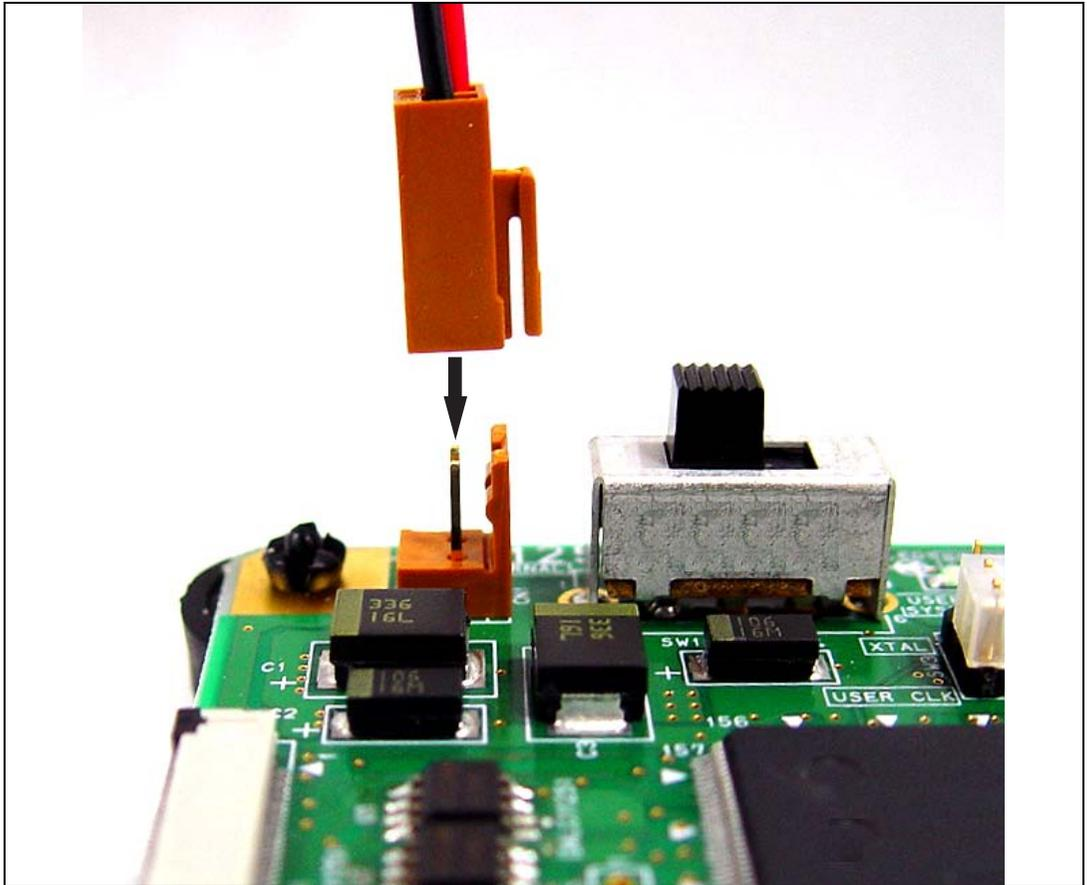
図 2.7 デバッグ MCU ボードと電源ケーブルの接続
