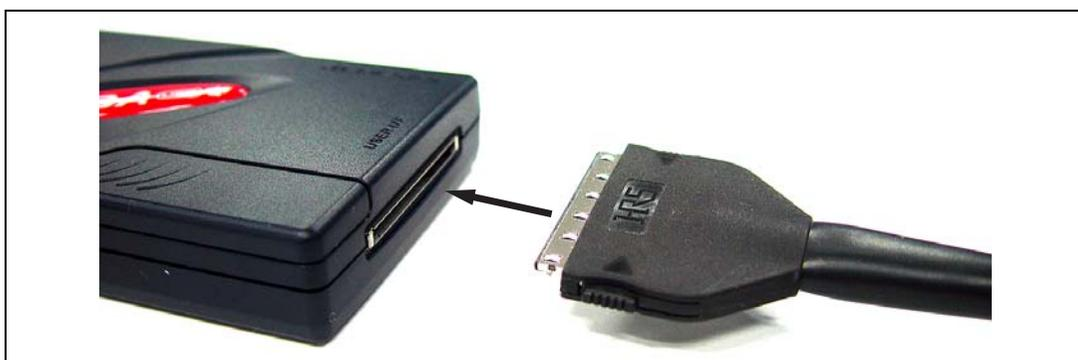
図 2.2 E10A-USB エミュレータとユーザインタフェースケーブルの接続
