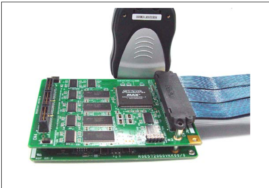
図 2.7 エミュレーションメモリユニット、エパチップユニット、およびトレースケープルの接続方法
