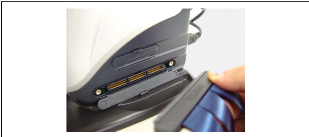
図 2.19 E200F 側のトレースケーブル接続方法
