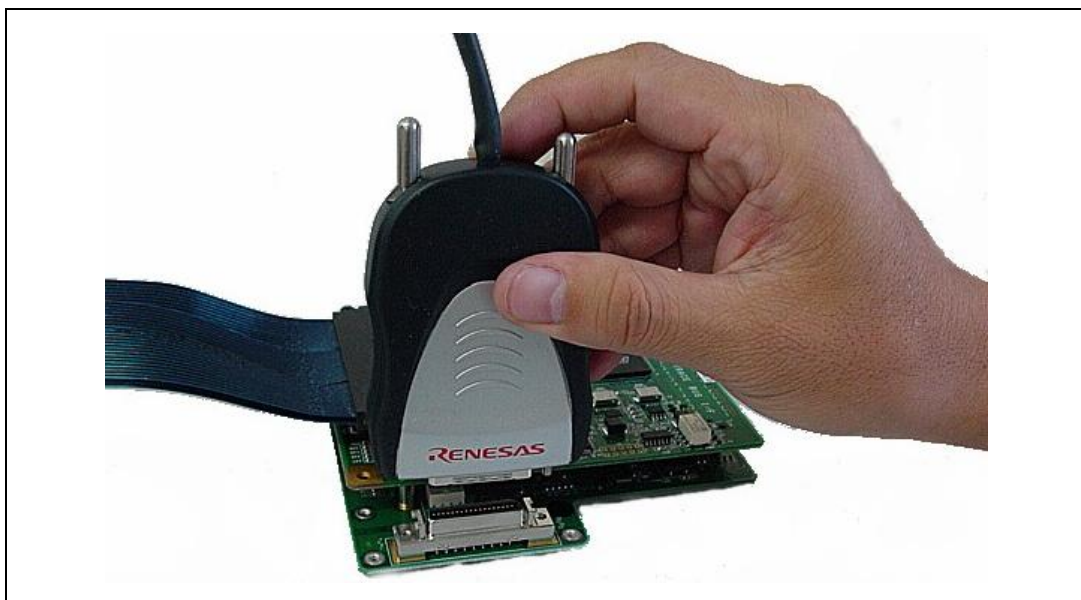
図 2.5 先端プローブとエバチップユニットの接続方法
