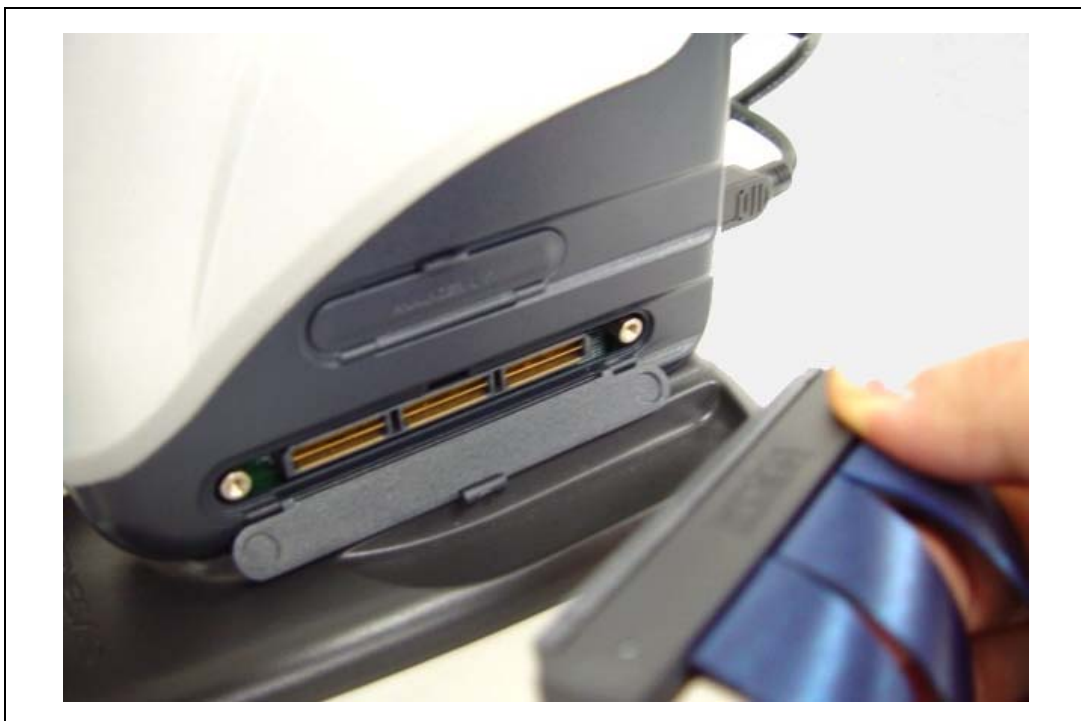
図 2.1 エバチップユニット使用時の E200F 側のトレースケーブル接続方法
