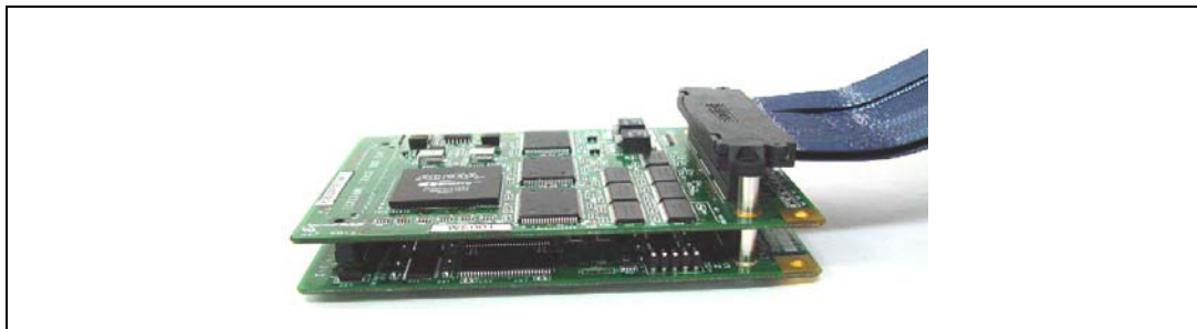
図 2.23 外部バストレーユニット、エミュレーションメモリユニット、およびトレースケーブルの接続方法
