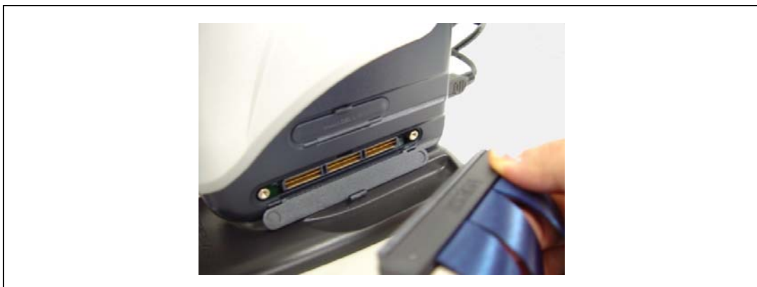
図 2.16 E200F 側のトレースケーブル接続方法
