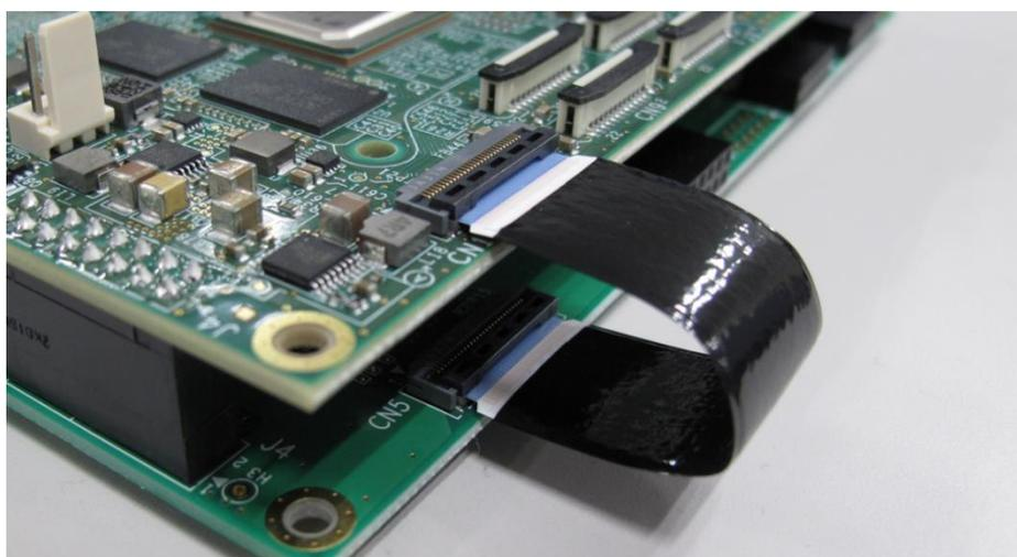
図 2.2 FFC を RZ/V2H Secure Evaluation Board に接続
