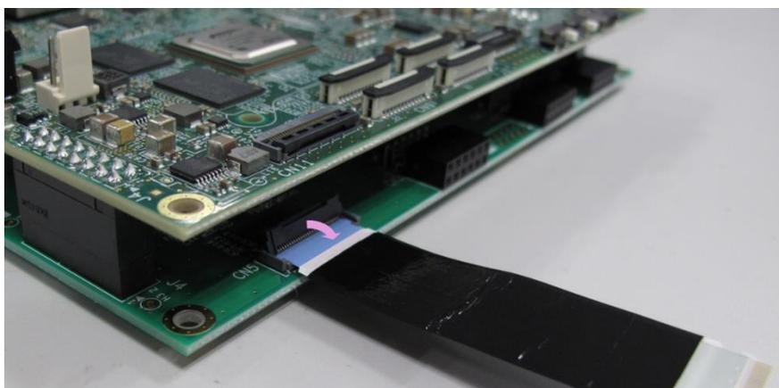
図 2.1 FFC を RZ/V2H EVK Expansion Board に接続
