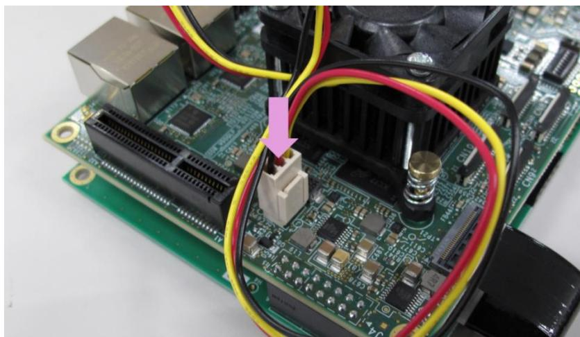
図 5.2 ヒートシンクファンの電源を接続
