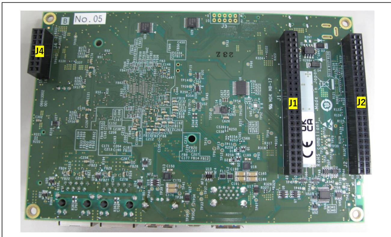
図 3.2 RZ/V2H Secure Evaluation Board (半田面)
