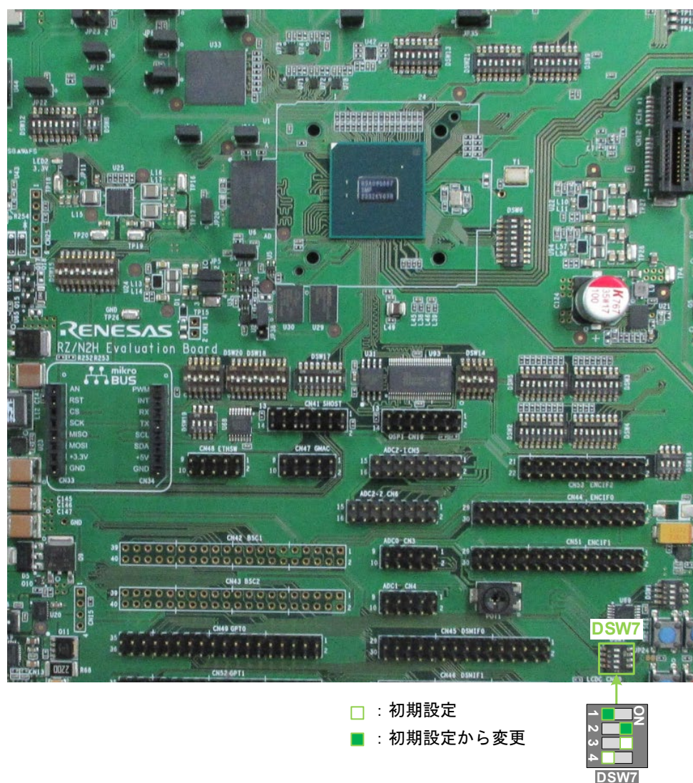
図 7-16 拡張 SPI コネクタ(CN19)使用時のスイッチ設定
