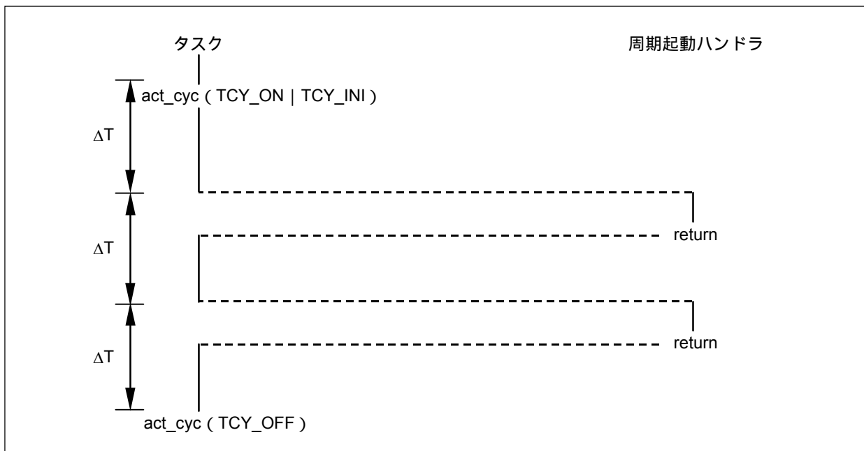
図7-3 act_cyc (TCY_ON | TCY_INI) 発行時の処理の流れ
