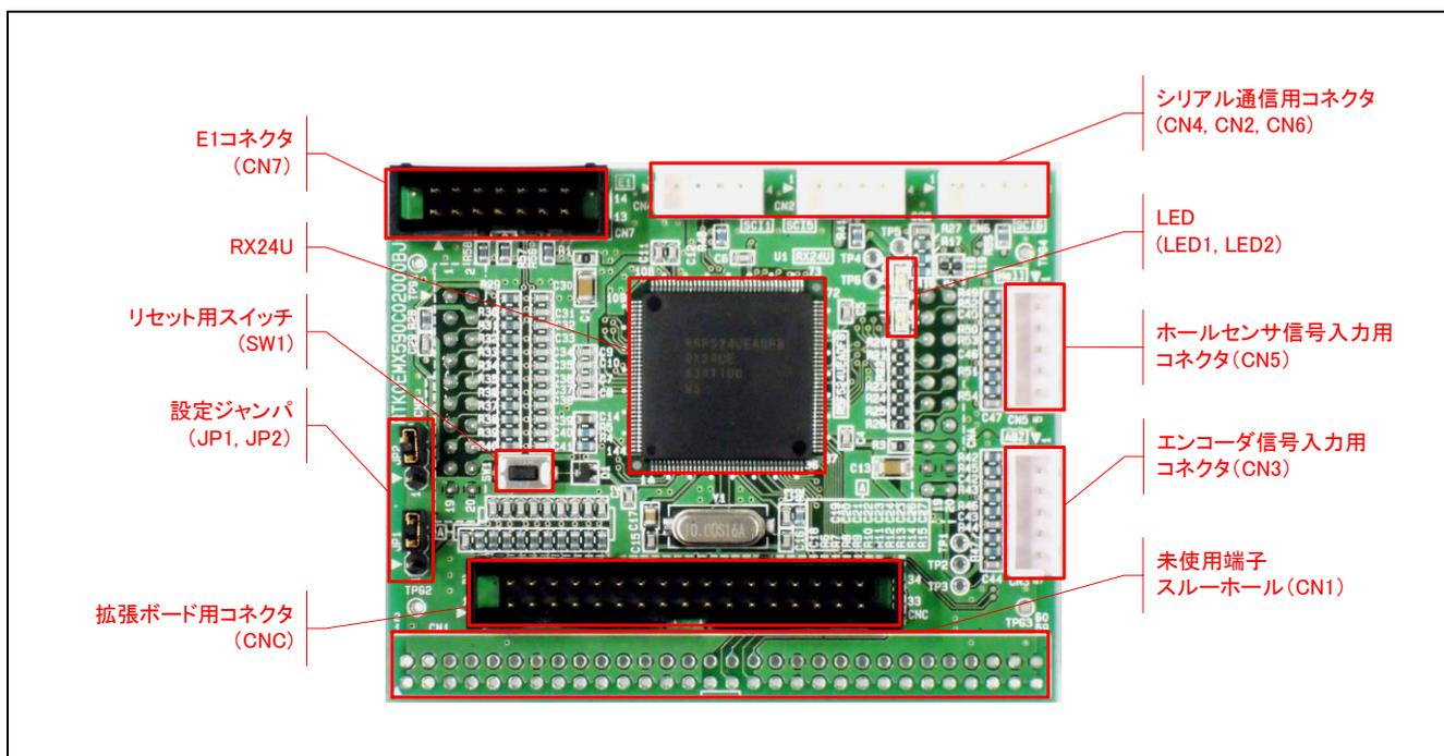
図 3.1 RX24U CPU カードレイアウト (表面)
