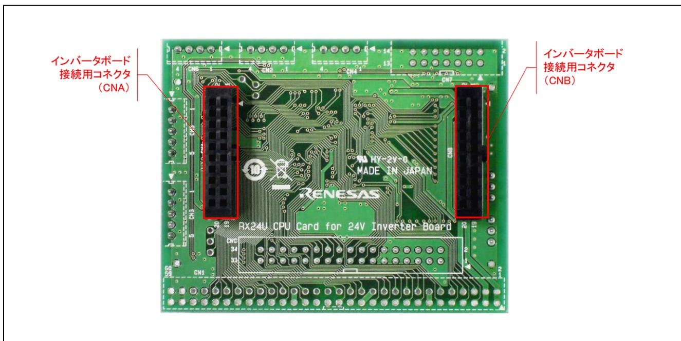
図 3.2 RX24U CPU カードレイアウト (裏面)
