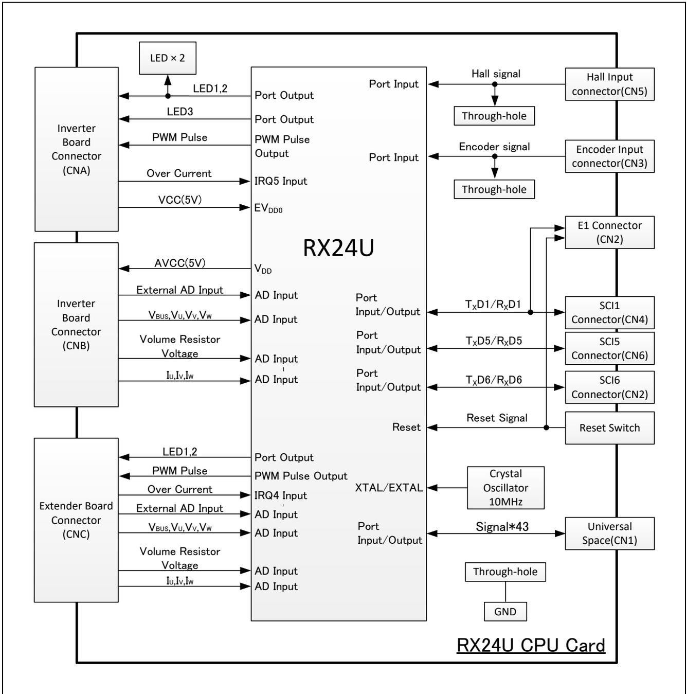
図 2.1 RX24U CPU カードブロック図
