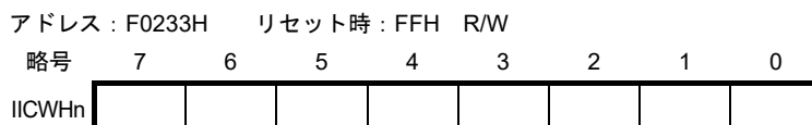
図15-11 IICAハイ・レベル幅設定レジスタn (IICWHn) のフォーマット
