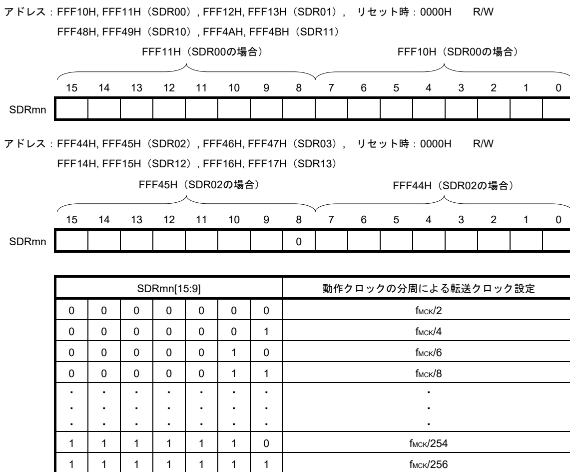
図14-9 シリアル・データ・レジスタmn (SDRmn) のフォーマット
