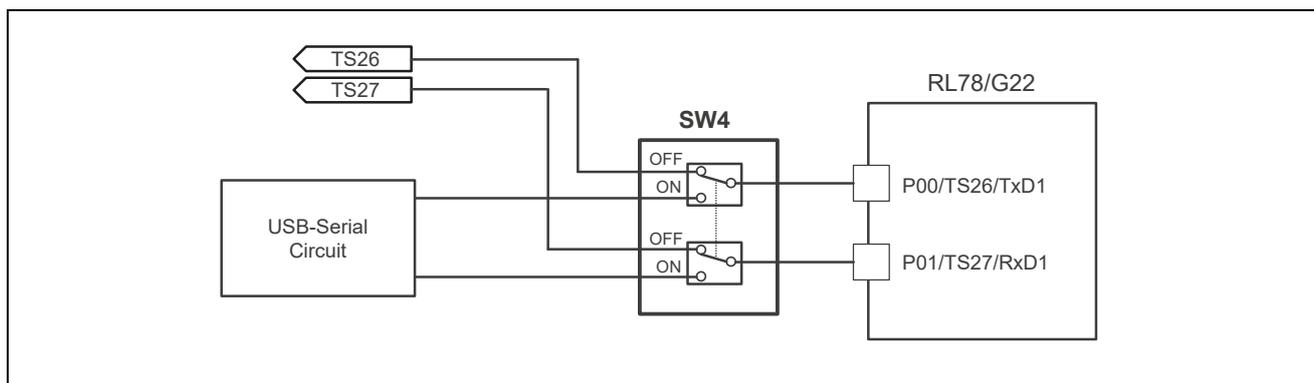
図 2-9 ボード機能選択スイッチ（SW4）回路
