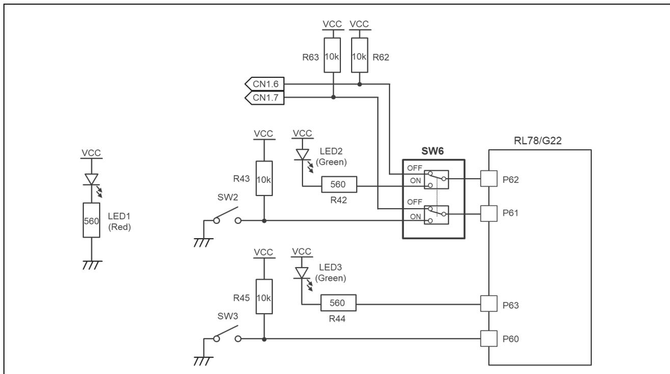
図 2-8 プッシュスイッチと LED 回路
