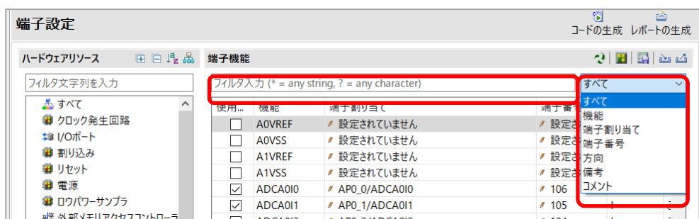
図 4-41 端子設定のフィルタリング
