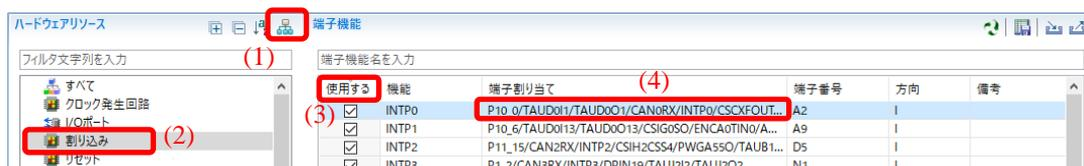
図 4-36 端子設定- [端子機能] リストの端子配置設定
