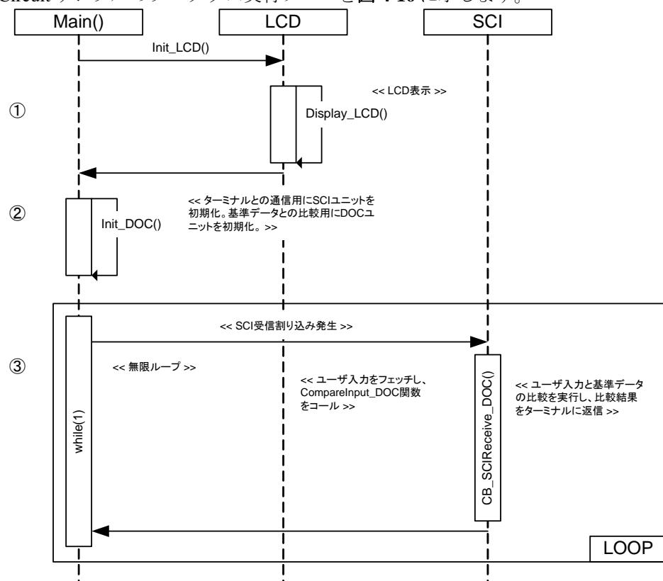
図 4-16: Data Operation Circuit フロー
