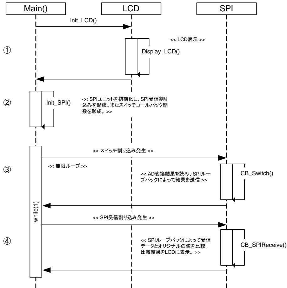
図 4-13: SPI\_Loopback フロー
