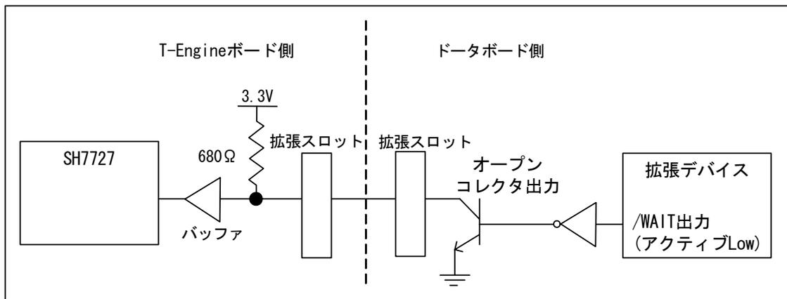
図 9.3 拡張スロットの/WAIT 端子の構成図
