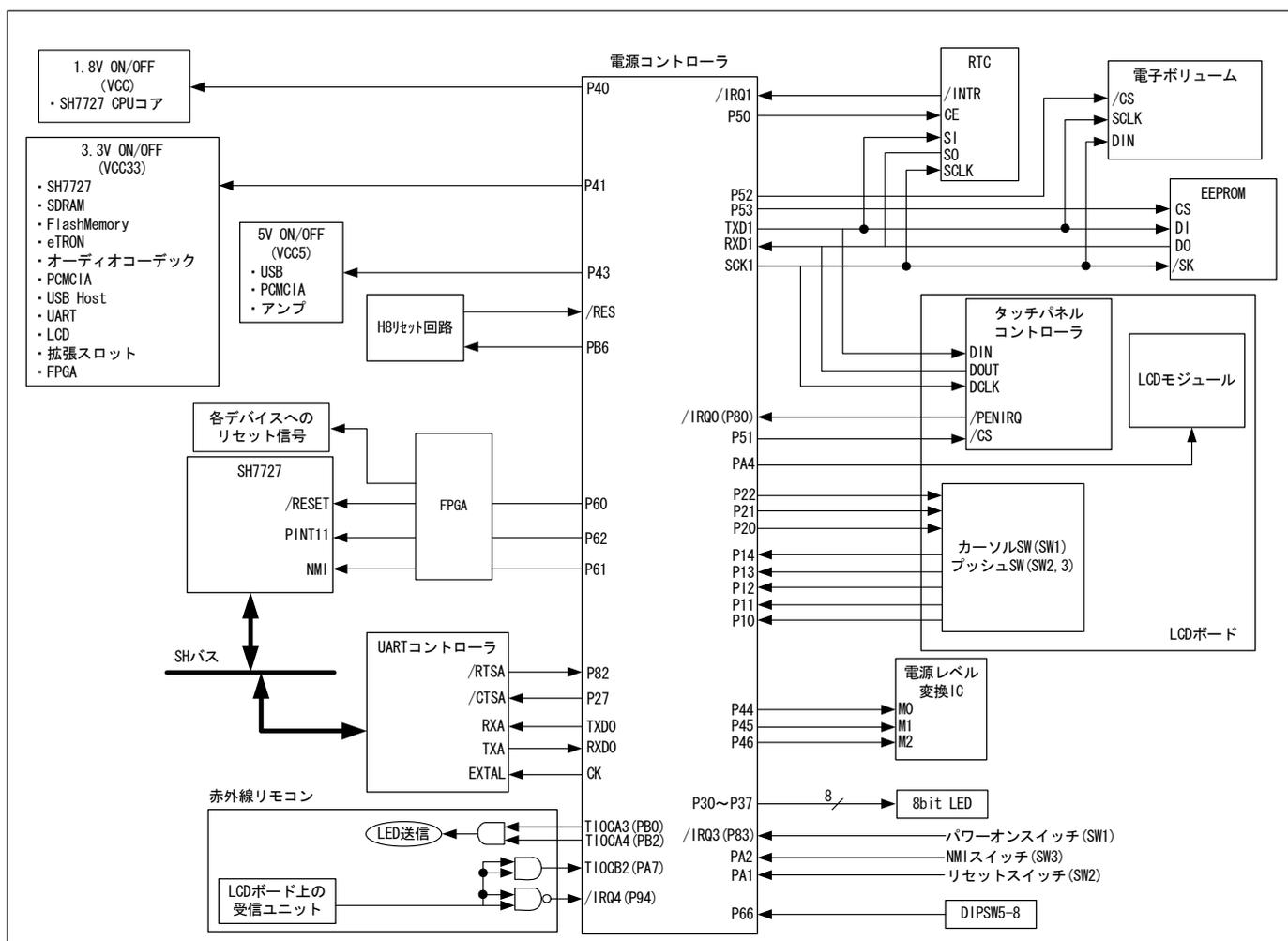
図 6.1 電源コントローラブロック図
