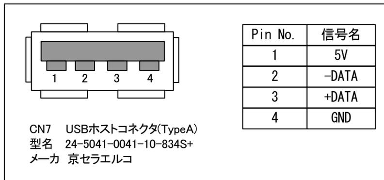
図 5. 3 USB ホストコネクタ (CN7) のピン配置
