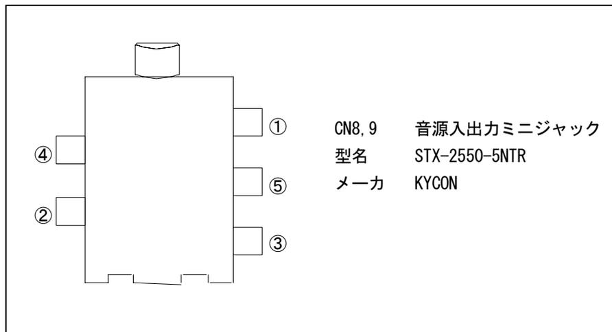
図 5.10 音源入出力ミニジャック (CN8、CN9) のピン配置
