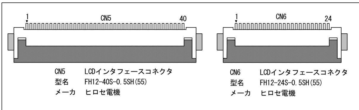
図 5.7 LCD インタフェースコネクタ (CN5、CN6) のピン配置
