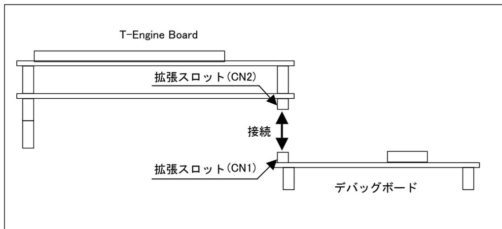
図 2.4 デバッグボードの接続方法
