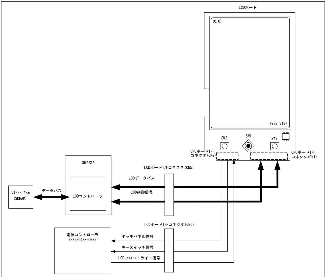
図 5.6 LCD 制御ブロック
