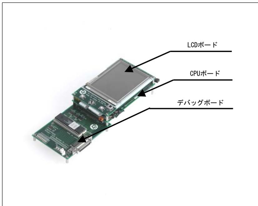
図1.2 T-Engineボードの外観
