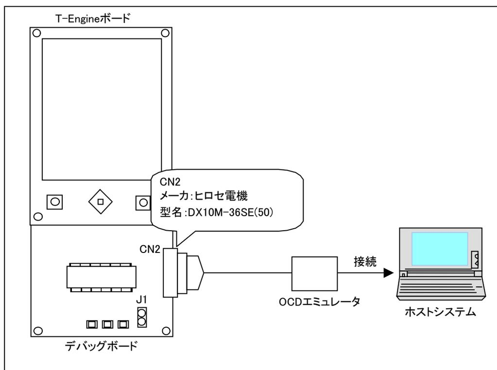
図 2.6 OCD エミュレータ接続方法
