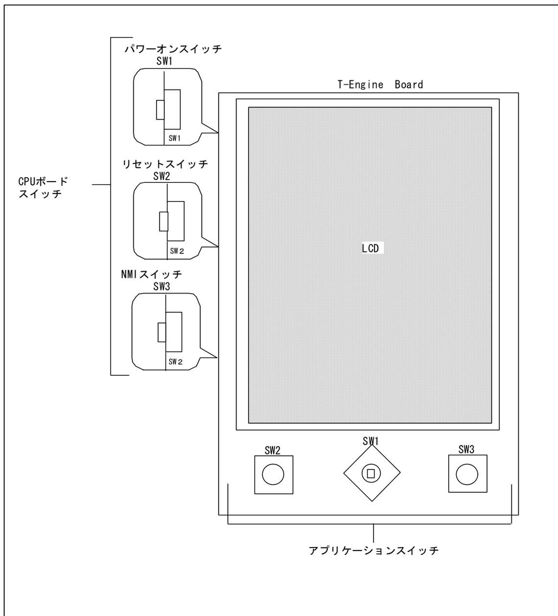
図 6.13 T-Engine ボードのスイッチ
