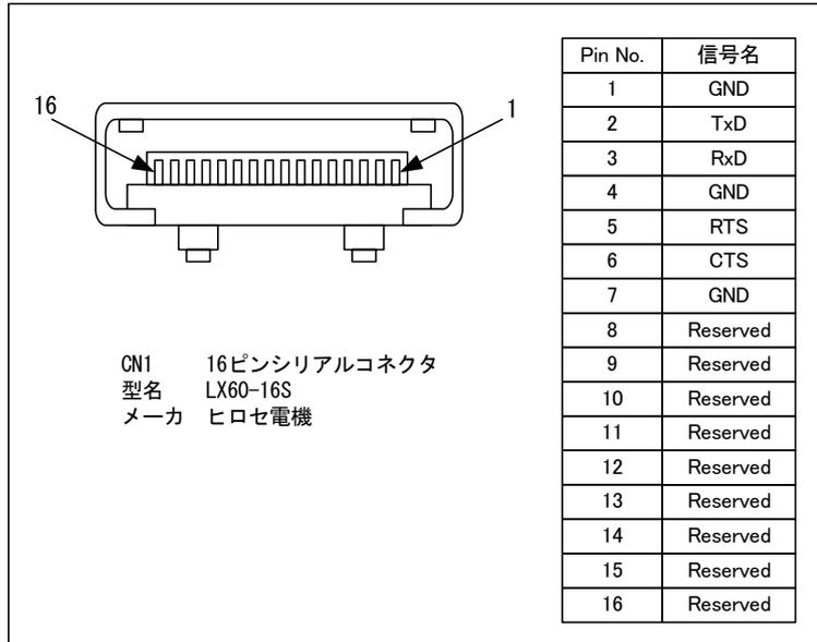
図 5. 5 15 ピンシリアルコネクタ (CN1)のピン配置
