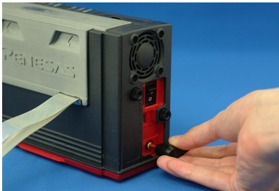
図2.5 エミュレータ用電源の接続
