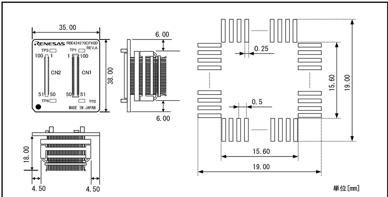
図4 寸法図及び参考フットパターン
