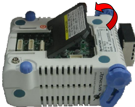
図2-1 アクリル板の取り外し方法
