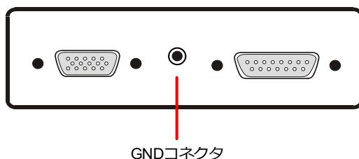
注：GND コネクタ（バナナジャックタイプ） 型名：PB4（HIRSCHMANN 社製）
