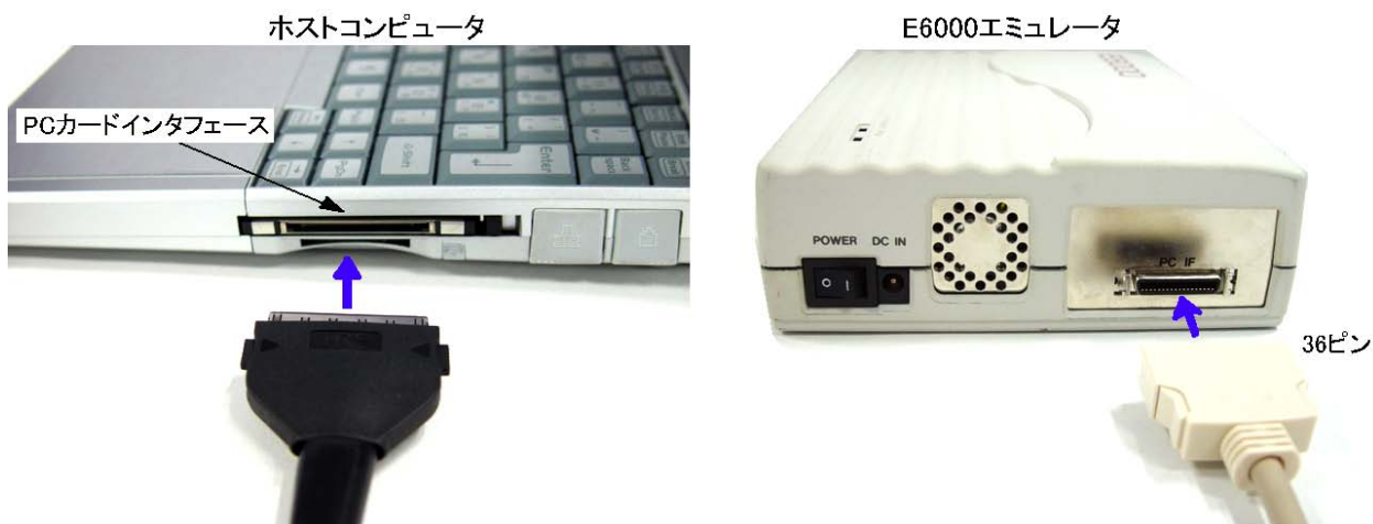
図 2 E6000 エミュレータと PC カードインタフェースとの接続
