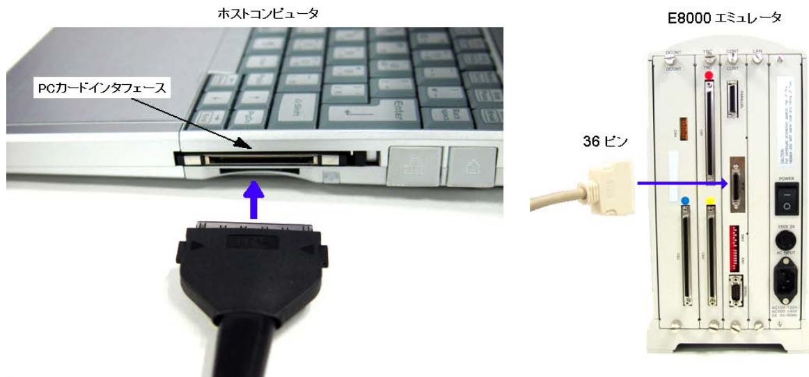
図 4 E8000 エミュレータと PC カードインタフェースとの接続
