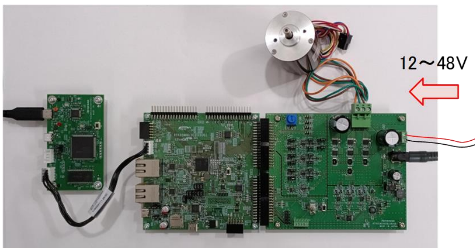
図 4-11 端子台から電源供給
