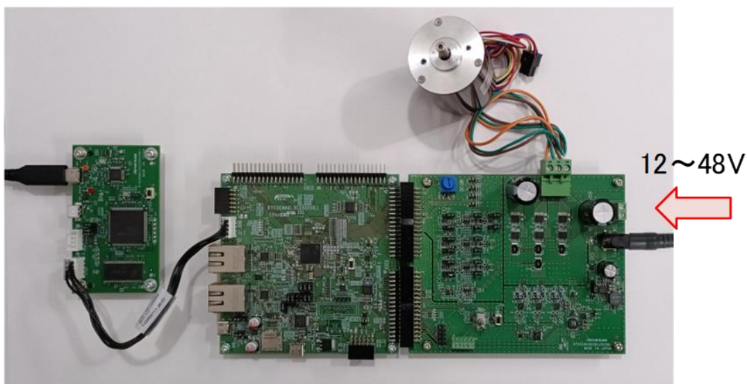
図 4-10 DC ジャックから電源供給
