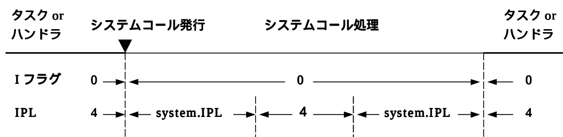
図 5.13 タスク独立部から発行できるシステムコール内での割り込み制御
