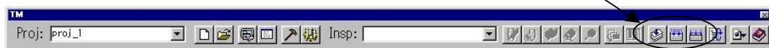
図 11 プロジェクトバーの[部分ビルド]、[ビルド]、[リビルド]ボタン
