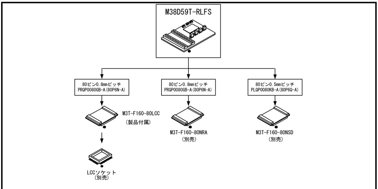
図6 ユーザシステムとの接続方法
