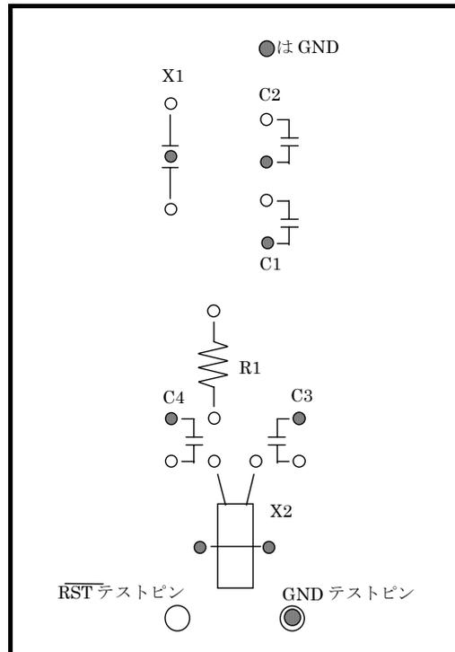
図2 発振回路部品配置
