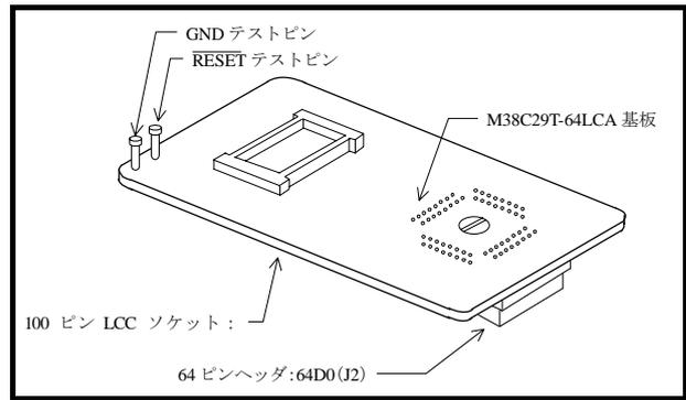
図1 M38C29T-LCAの外観
