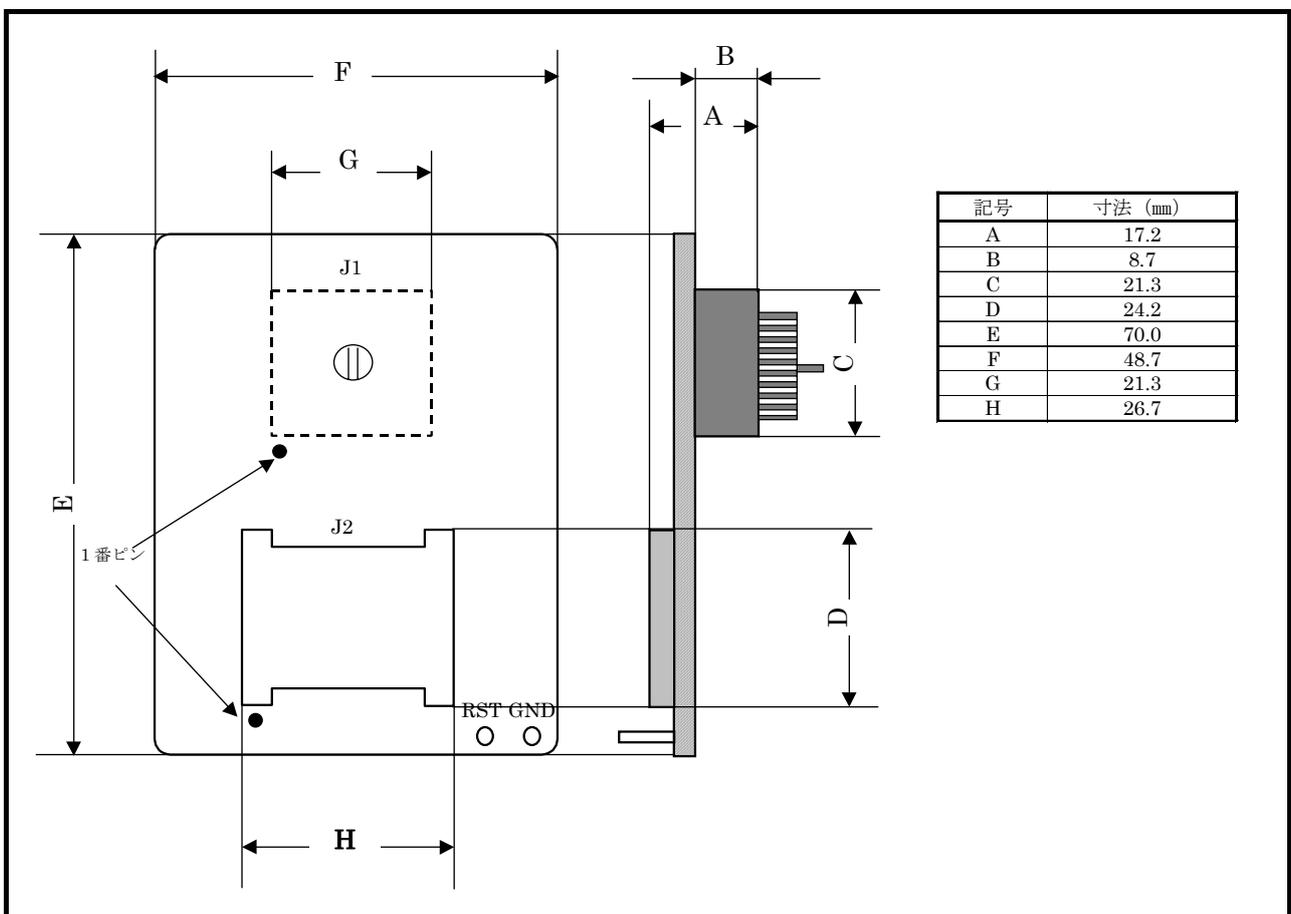
図6 M38C29T-64LCA寸法図
