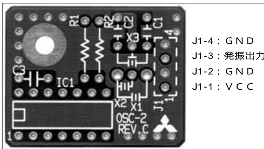
図 6.2 発振小基板のネクタピンアサイン
