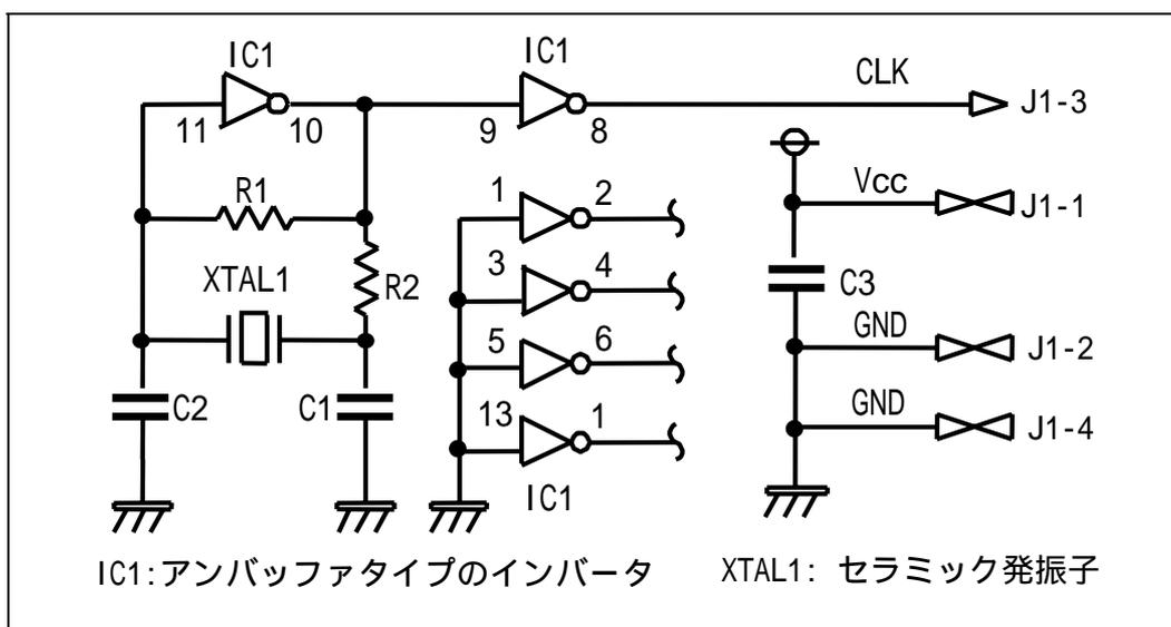
図 6.3 発振小基板 (OSC-2) の回路
