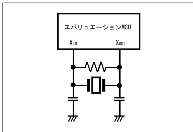
図2.23 エミュレータでは使用できない発振回路
