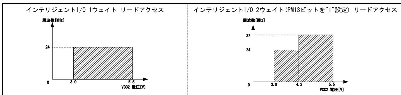
図1.7 エミュレーションメモリ基板(R0E330850MSRC0)接続での2電源動作時(VCC1=5.0±0.2[V]固定)
