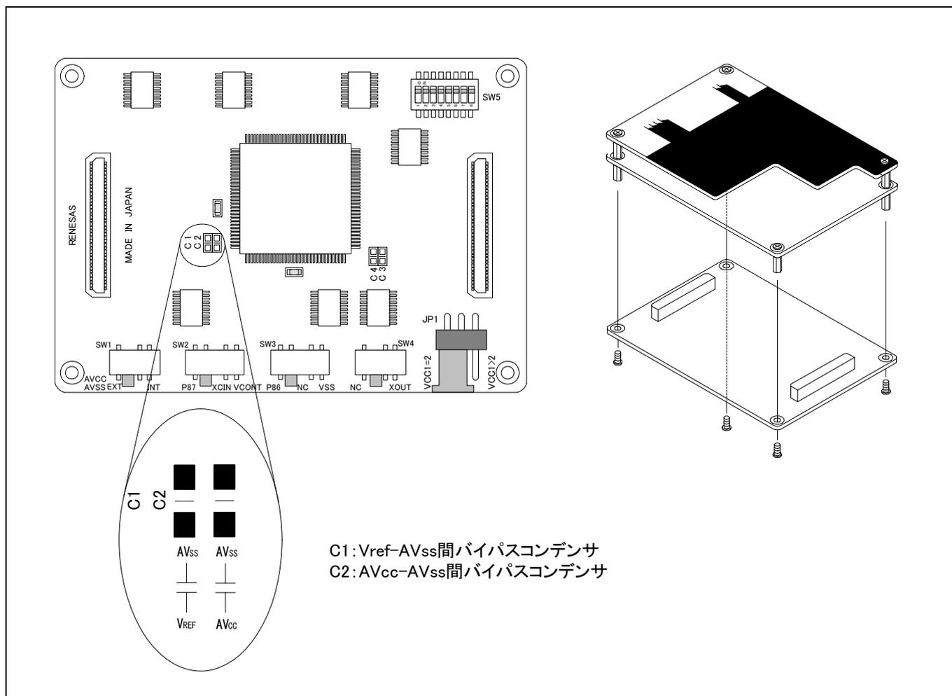
図2.24 A/Dコンバータ用バイパスコンデンサの取り付け位置と本製品の構造
