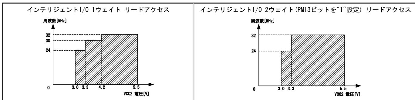
図4.3 エミュレーションメモリ基板(R0E330850MSRC0)未接続での2電源動作時 (VCC1=5.0±0.2[V]固定)
