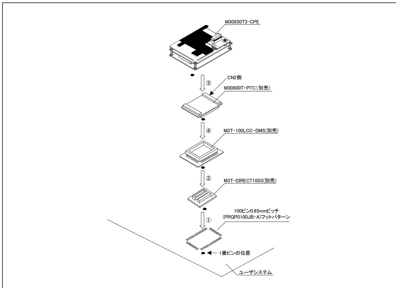
図2.14 100ピン0.65mmピッチフットパターンへの接続(その2)
