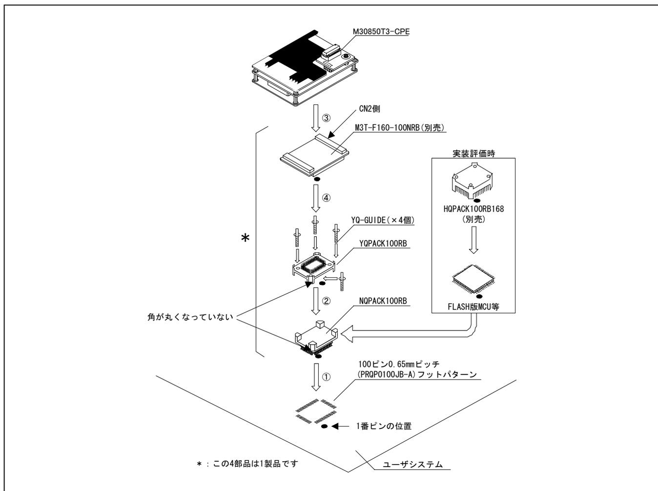
図2.13 100ピン0.65mmピッチフットパターンへの接続(その1)
