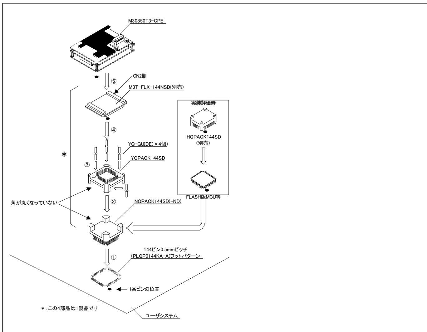
図2.17 144ピン0.5mmピッチフットパターンへの接続
