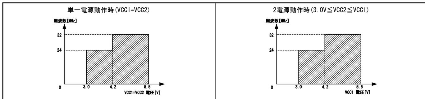
図1.3 実MCUの電圧と動作周波数
