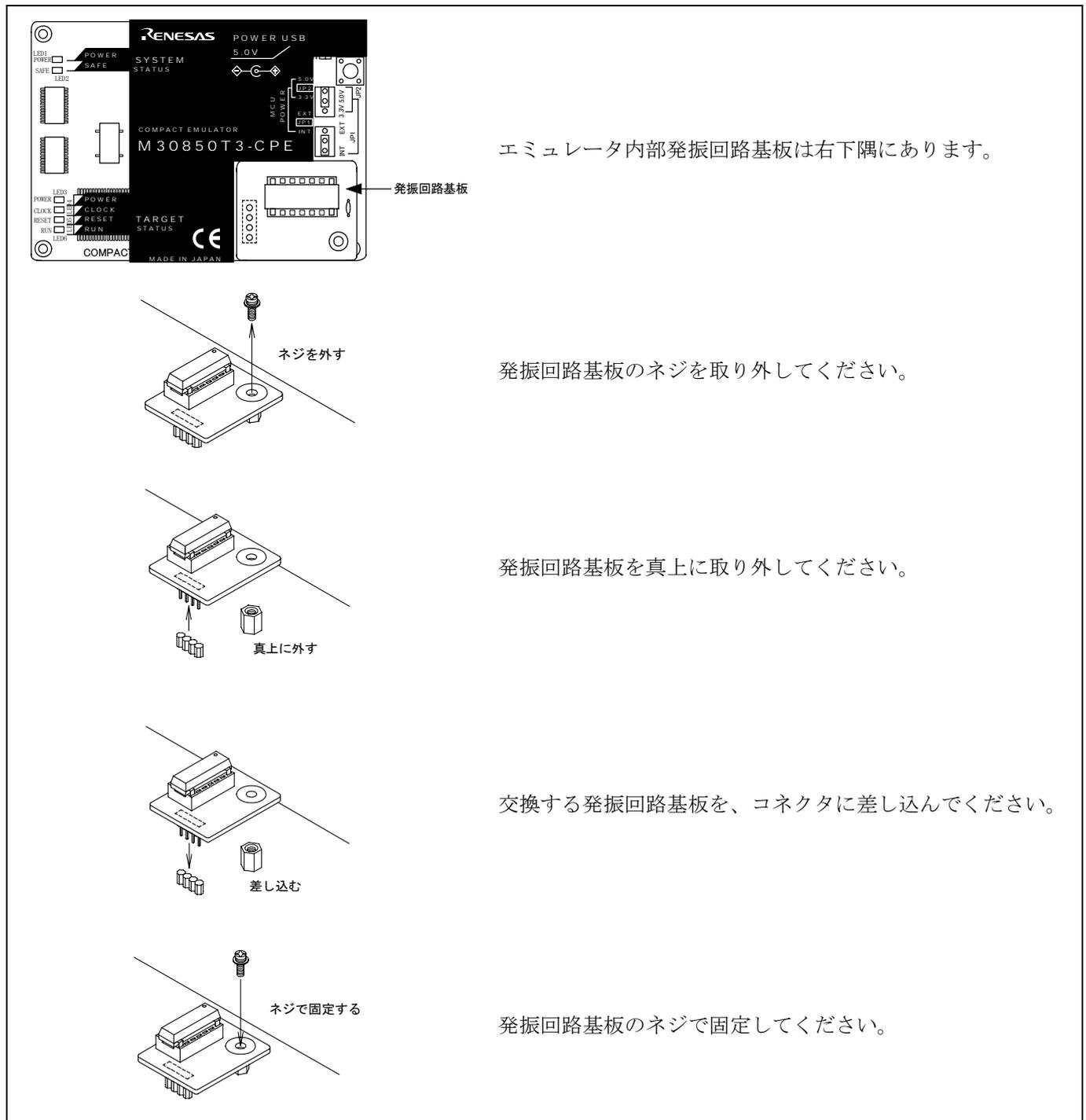
図2.19 発振回路基板の交換手順
