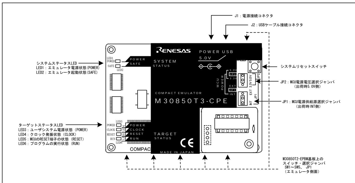
図1.2 エミュレータ各部の名称(M30850T3-CPE上面)
