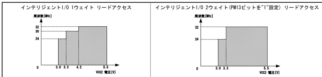
図1.5 エミュレーションメモリ基板(R0E330850MSRC0)未接続での2電源動作時(VCC1=5.0±0.2[V]固定)
