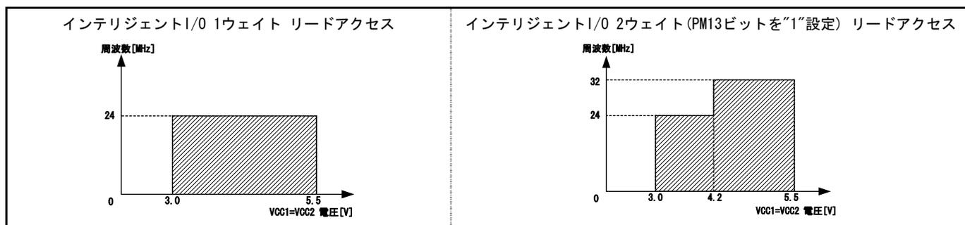
図4.4 エミュレーションメモリ基板(R0E330850MSRC0)接続での単一電源動作時 (VCC1=VCC2)
