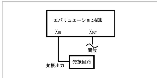
図2.22 ユーザシステム上発振回路の使用
