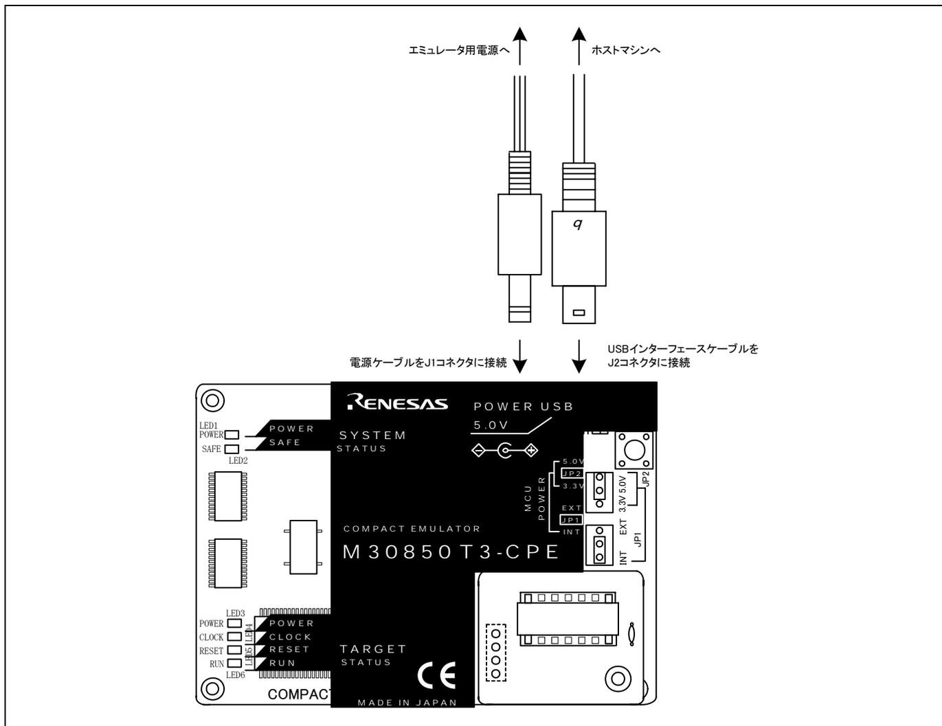
図2.5 エミュレータシステムの接続
