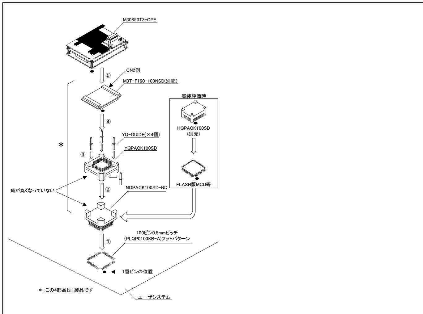
図2.16 100ピン0.5mmピッチフットパターンへの接続
