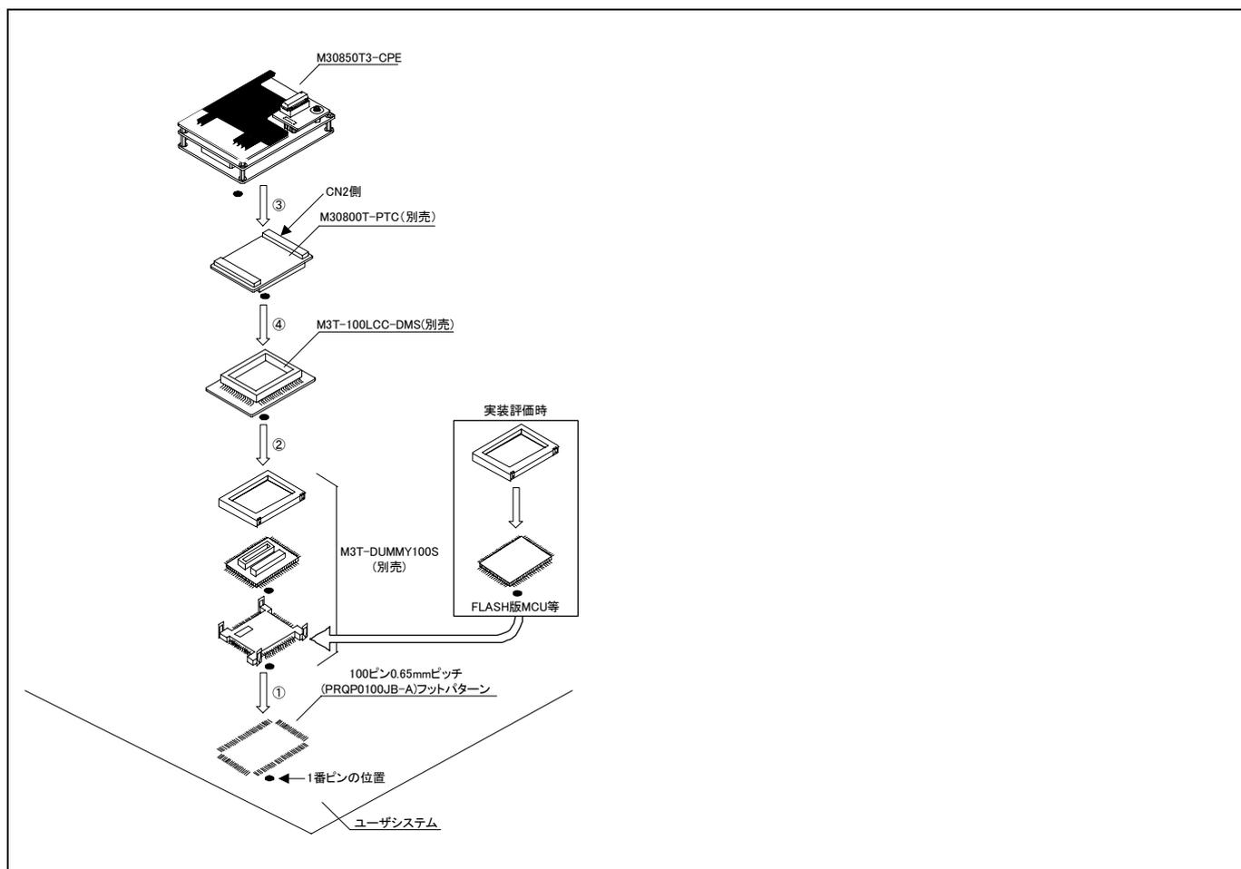
図2.15 100ピン0.65mmピッチフットパターンへの接続(その3)
