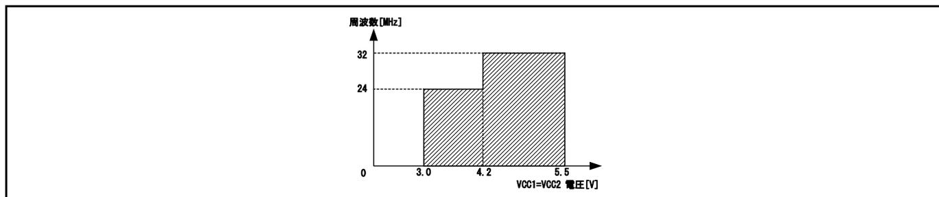
図4.2 エミュレーションメモリ基板(R0E330850MSRC0)未接続での単一電源動作時 (VCC1=VCC2)
