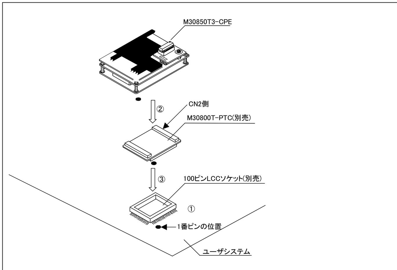
図2.12 100ピンLCCソケットへの接続
