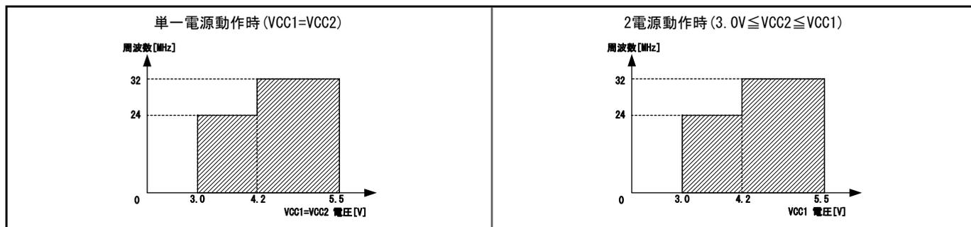
図4.1 実MCUの電圧と動作周波数
