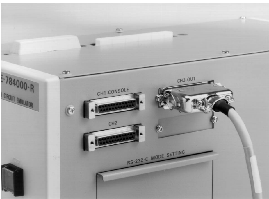
写真2-5 PCバス・インタフェース・ケーブルの接続
