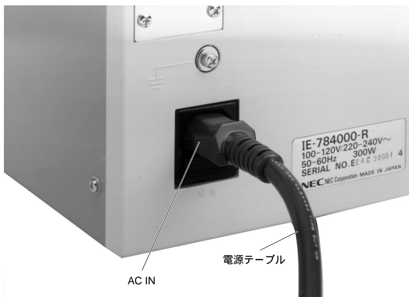
写真2-4 電源ケーブルの接続
