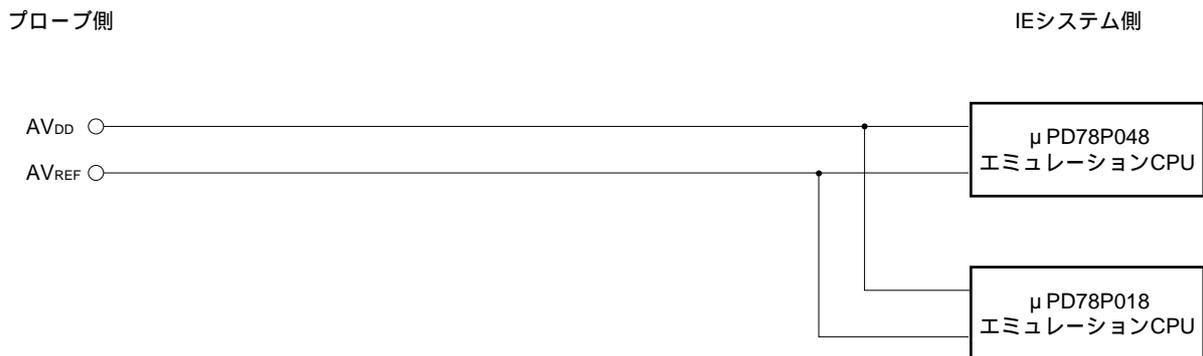
図4 - 4 エミュレーション回路の等価回路4
