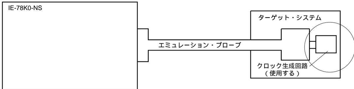
**備考** ターゲット・システム上（円内）のクロック生成回路より供給されるクロックを使用します。
