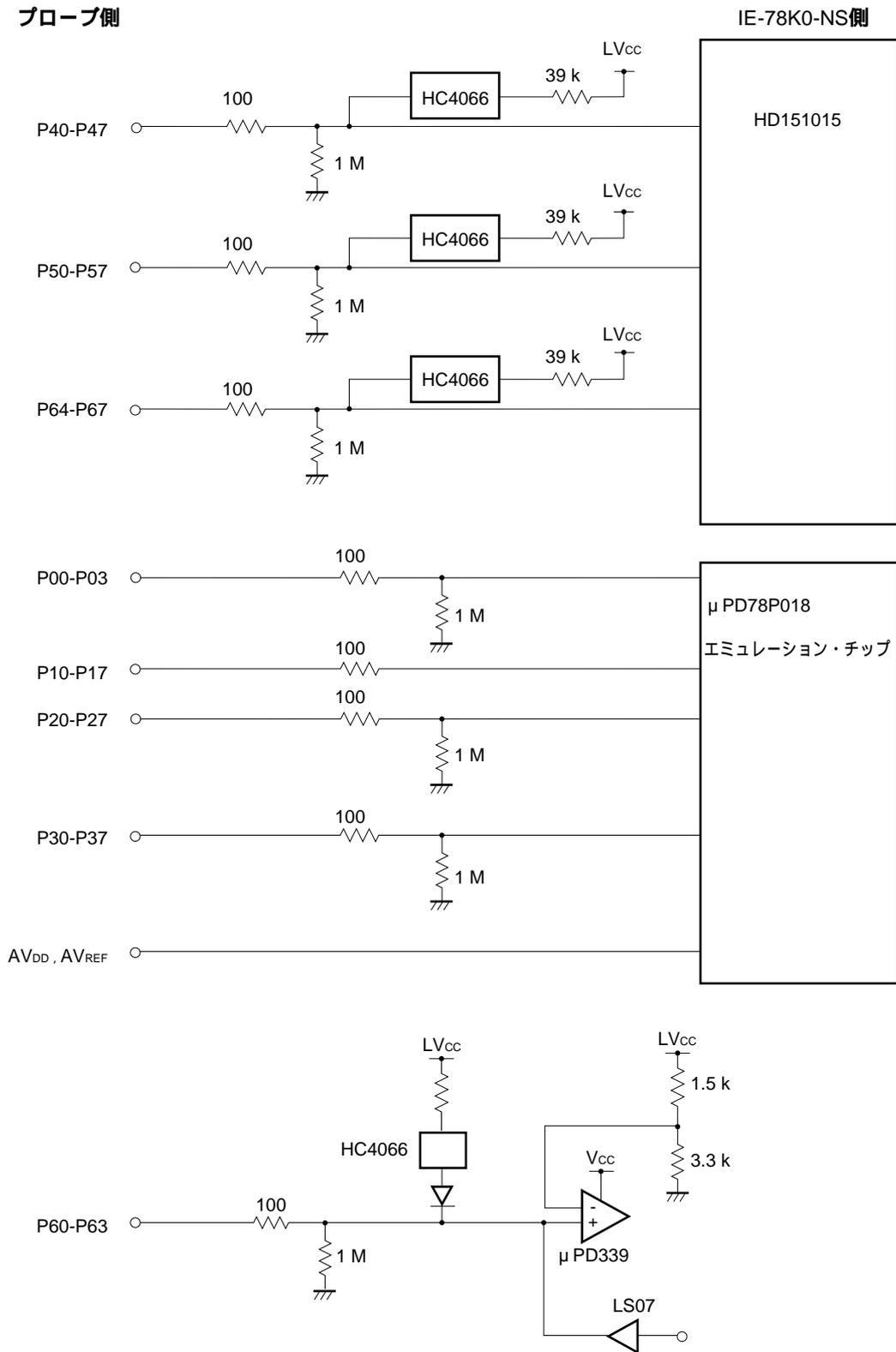
図4-2 エミュレーション回路の等価回路2
