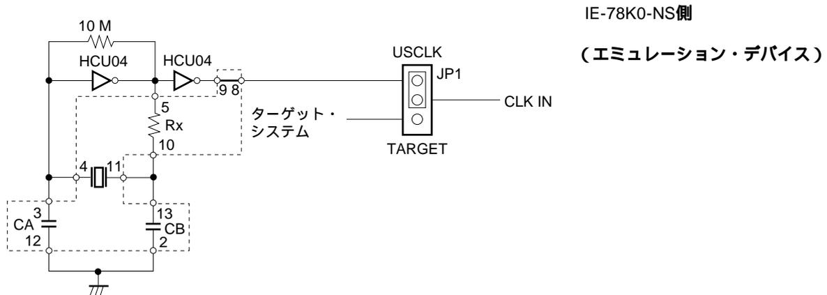
**備考** 破線で囲まれた箇所は、部品台に取り付ける部品を表します。
