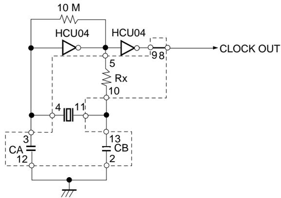
**備考** 破線で囲まれた箇所は、部品台に取り付ける部分を示します。
