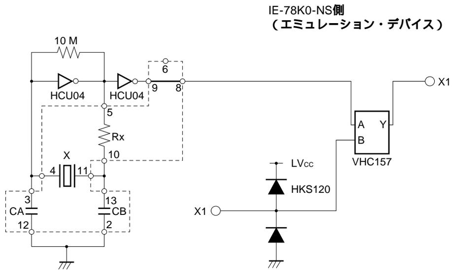
**備考** 破線で囲まれた箇所は、部品台に取り付ける部品を示します。
