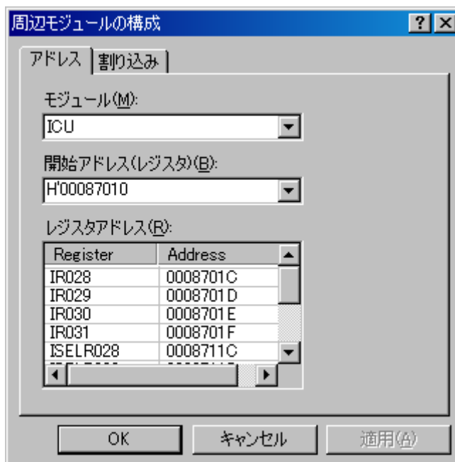
図 3-11 周辺モジュールの構成ダイアログボックス (アドレスタブ)
