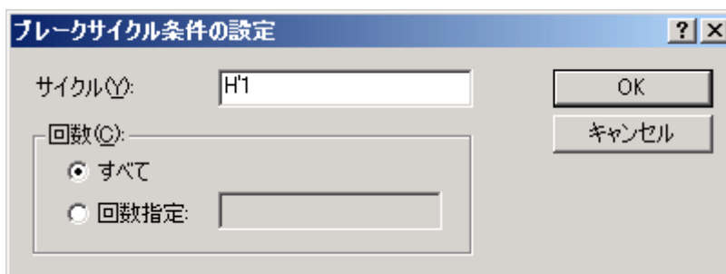
図 3-22 ブレークサイクル条件の設定ダイアログボックス
