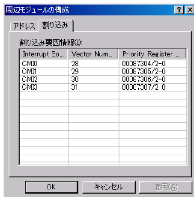
図 3-12 周辺モジュールの構成ダイアログボックス (割り込みタブ)
