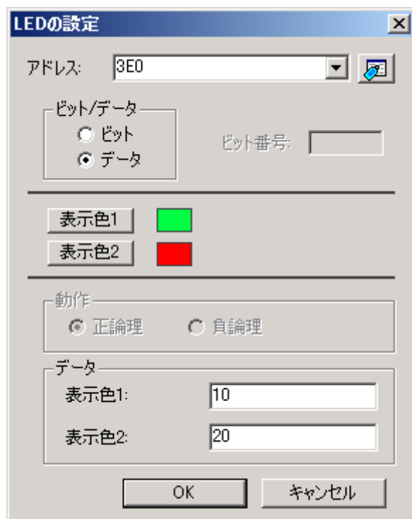
図 3-72 LED の設定ダイアログボックス (データ指定)
