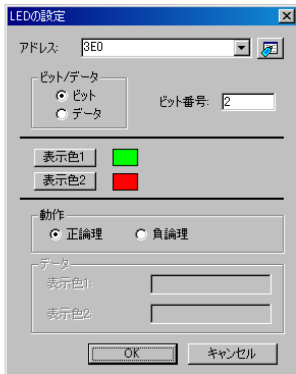
図 3-71 LED の設定ダイアログボックス (ビット指定)
