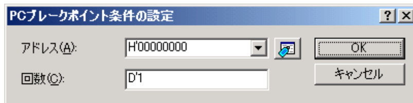
図 3-18 PC ブレークポイント条件の設定ダイアログボックス
