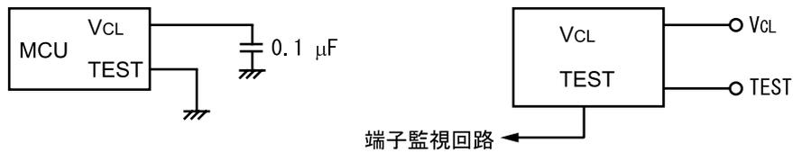
図 2-4  $V_{CL}$ 、TEST信号回路
