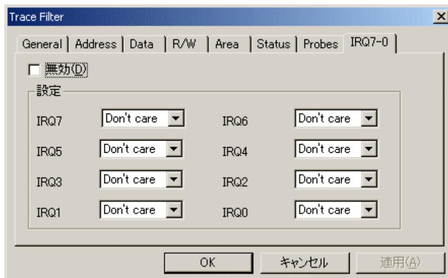
図 5-53 Trace Filter ダイアログボックス(IRQ7-0 ページ)
