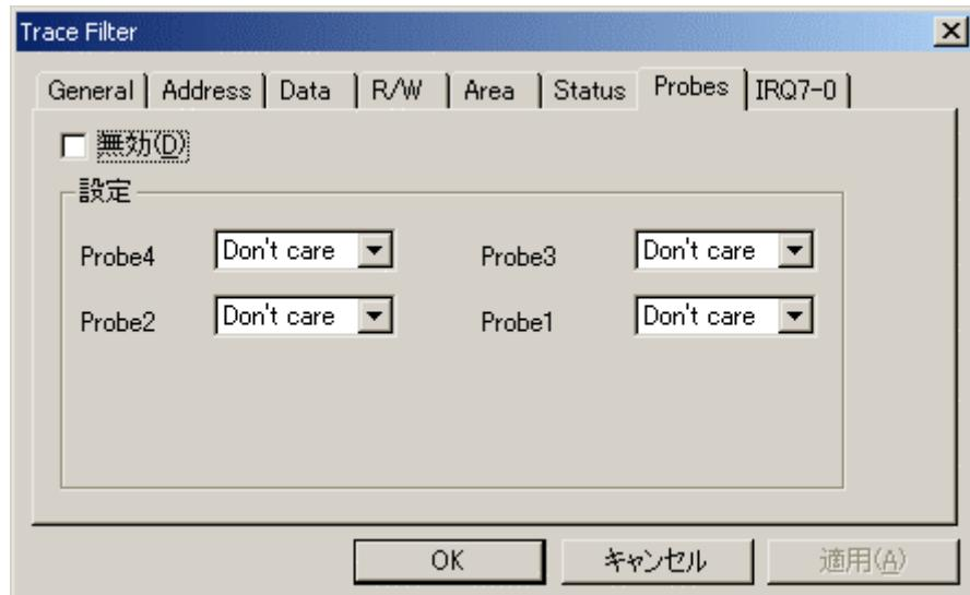
図 5-52 Trace Filter ダイアログボックス(Probes ページ)
