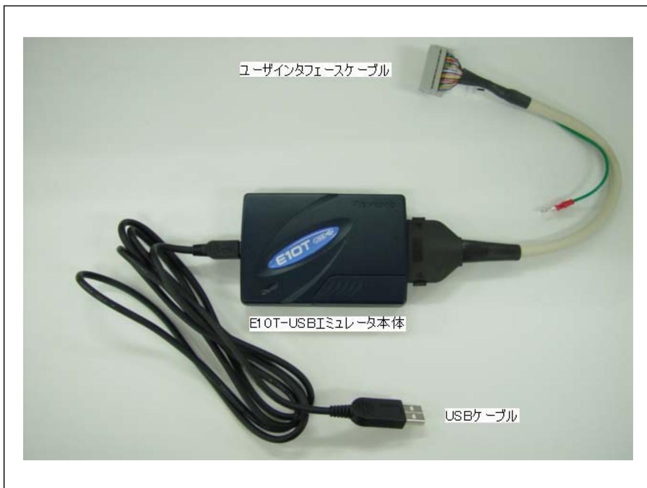
図 3.2 E10T-USB エミュレータのハードウェア構成 (20 ピンケーブル時)
