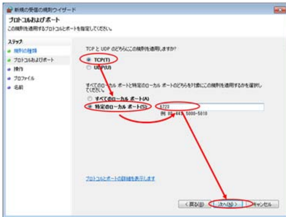
図 2.10 新規の受信の規則ウィザード (プロトコルおよびポート)
